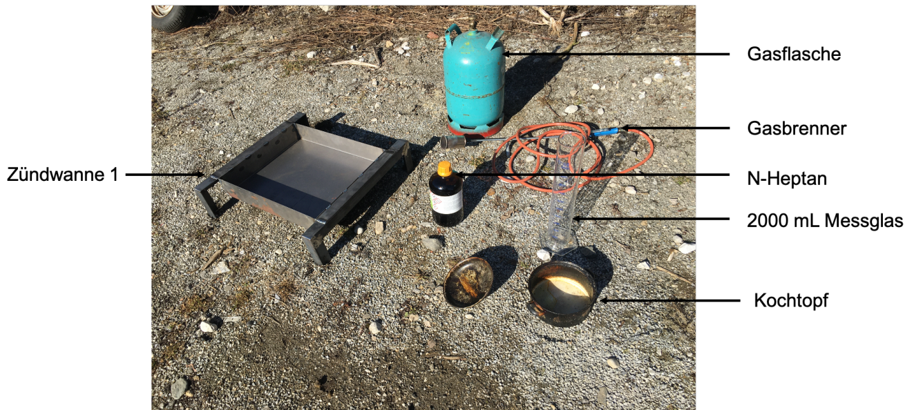
Abbildung 11: Utensilien für Zündungsversuche für die Normkrippe
