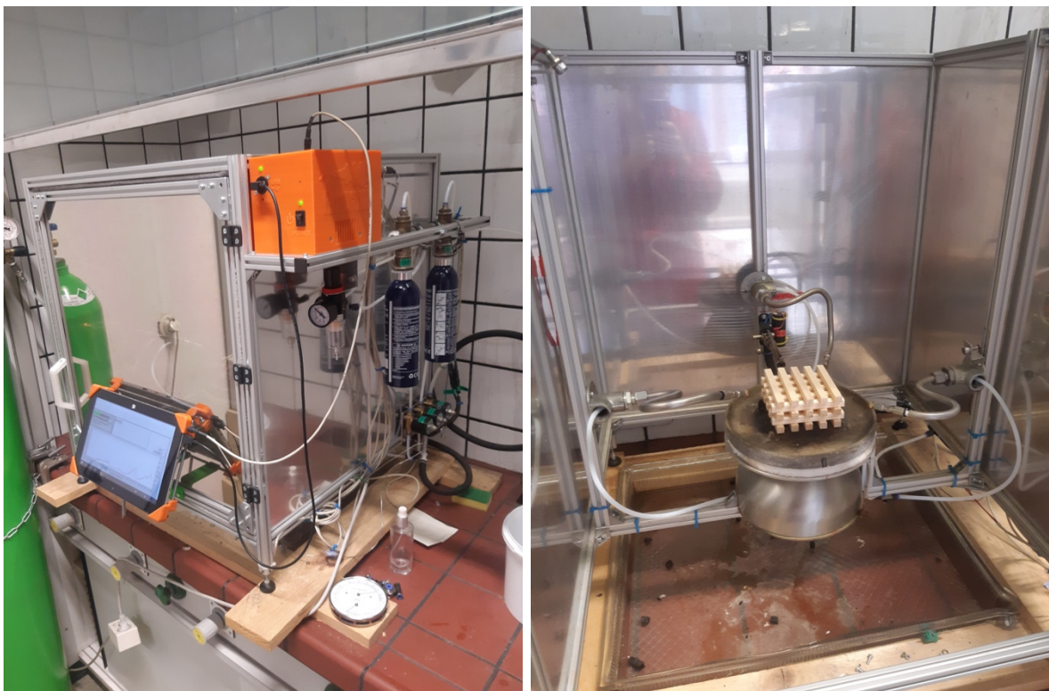
Abbildung 5: Aufbau der automatisierten Laborlöschvorrichtung (24)
