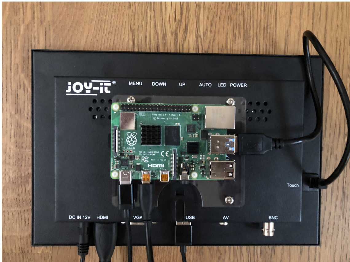
Abbildung 7.1: Betriebsbereiter Bildschirm mit montiertem, verkabeltem Raspberry Pi
