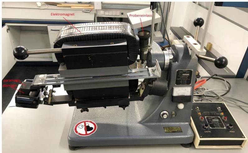
Abbildung 11: Frantz Magnetscheider am Lehrstuhl für Geologie und Lagerstättenlehre an der Montanuniversität Leoben; Die Probe wird in den Trichter rechts oben eingeführt.
