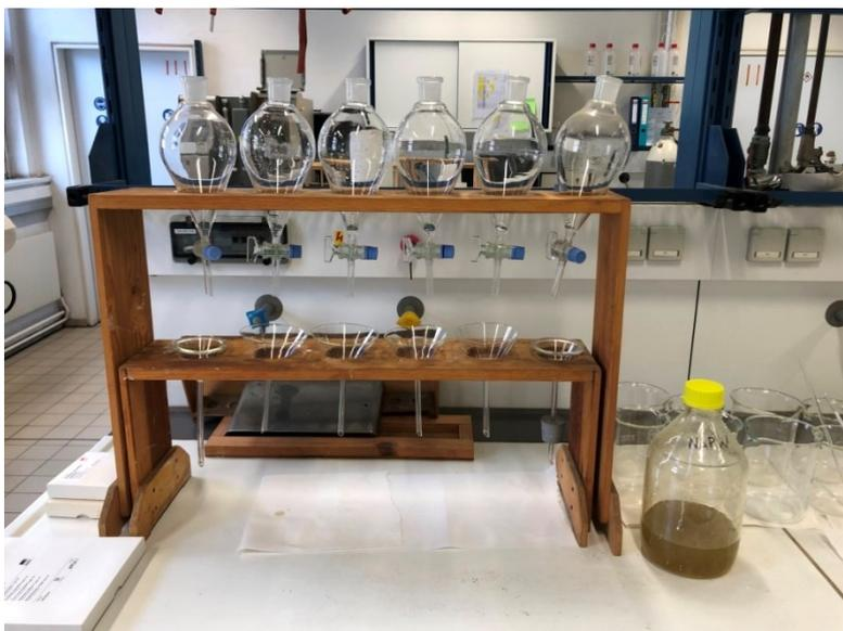
Abbildung 12: Kolben mit Ablass für das Schwermineralkonzentrat und Auffangtrichtern; Rechts das Natriumpolywolframat
