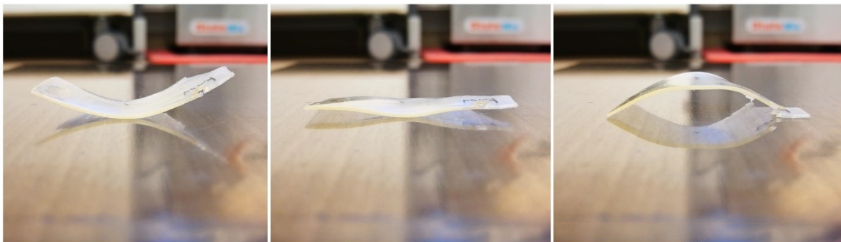
Abbildung 39: Übergang eines GDGDA-SH14 Prüfkörpers von seiner temporären Form (links) hin zu seiner permanenten Form (rechts). Der Prüfkörper wurde durch eine Heißluftpistole erwärmt.
