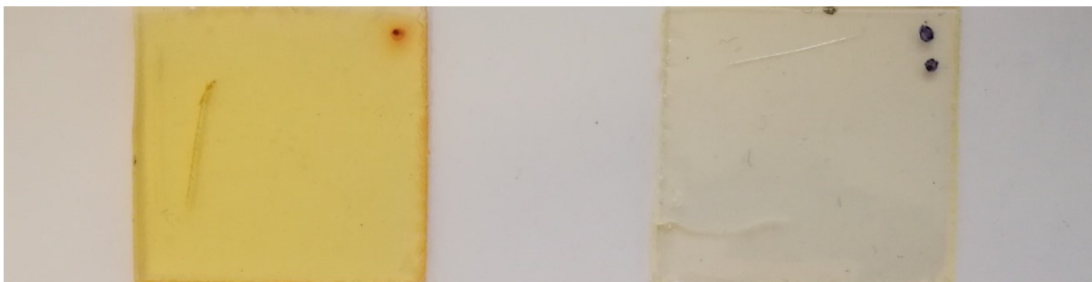
Abbildung 32: SH14-Probenkörper nach 3 Tagen bei 160 °C, links unter Luft, rechts unter Vakuum.
