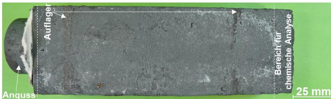
Abbildung 3-4: Biegeprobe im Gusszustand
