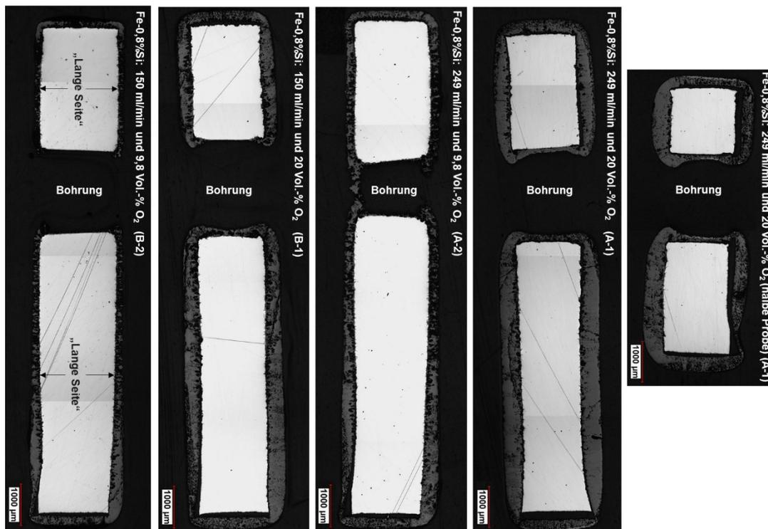
Abbildung 4-13: Schliffmosaik der einzelnen Proben von Legierung III
