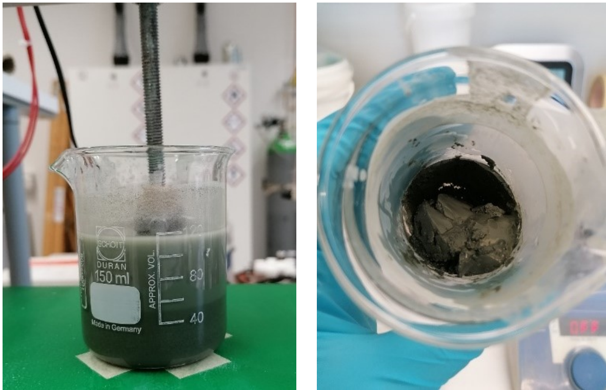
Abbildung 19: links: deutliche Ausbildung von zwei Schichten im Slurry während des Tauchvorgangs, rechts: Schlamm aus Partikeln, der sich am Boden des Becherglases absetzt, nachdem die flüssige Phase abgossen wurde (Fotos vom 12.08.2020)
