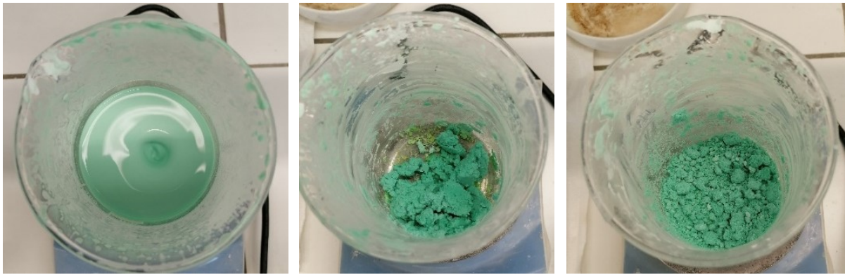
Abbildung 17: links: Slurry aus Aluminiumoxid, Nickelnitrat-Hexahydrat und destilliertem Wasser, Mitte: Start des Verdampfungsprozesses, rechts: fortgeschrittener Prozess der Verdampfung von Wasser (Fotos vom 11.08.2020)
