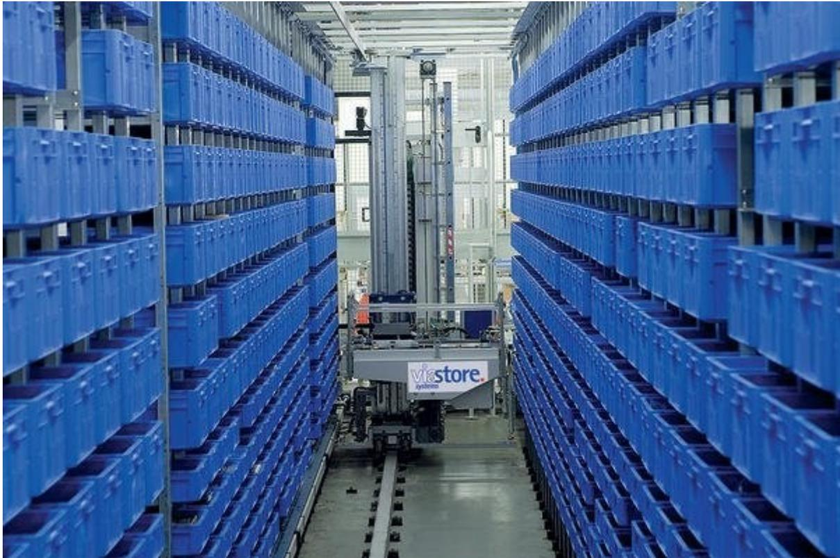
Abbildung 15: Regalbediengerät für KLT (Hersteller Viastore)<sup>217</sup>
