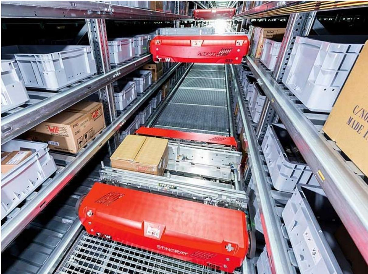
Abbildung 16: Beispiele einer Shuttleanlage (Hersteller TGW)<sup>222</sup>
