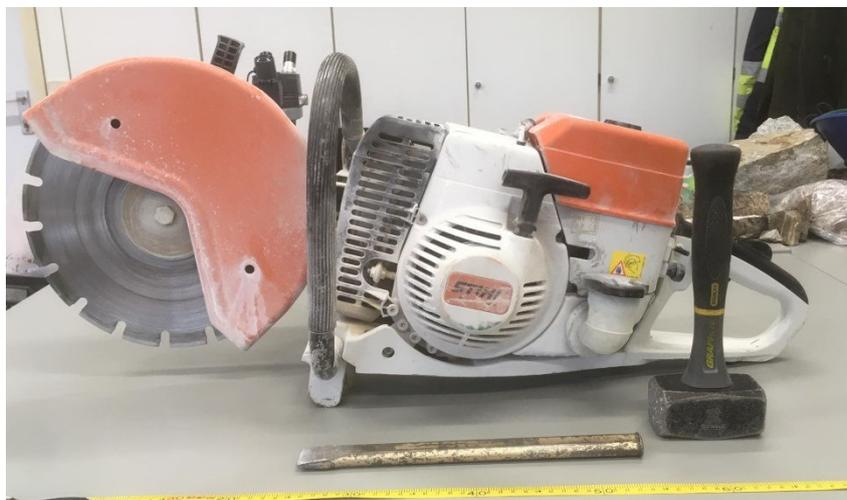
Abbildung 13: Werkzeug für die Probennahme. Unterer Bildrand: 80 cm.
