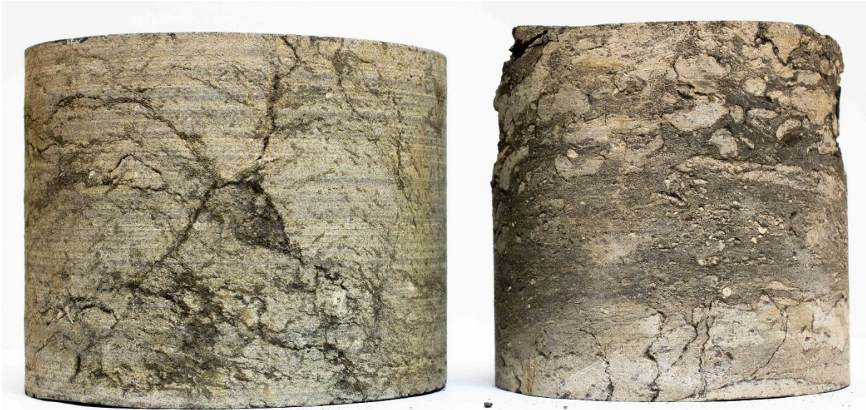
Abbildung 30: Bohrkernabschnitte der Zigzag Schichten zur Entnahme der Plugs
