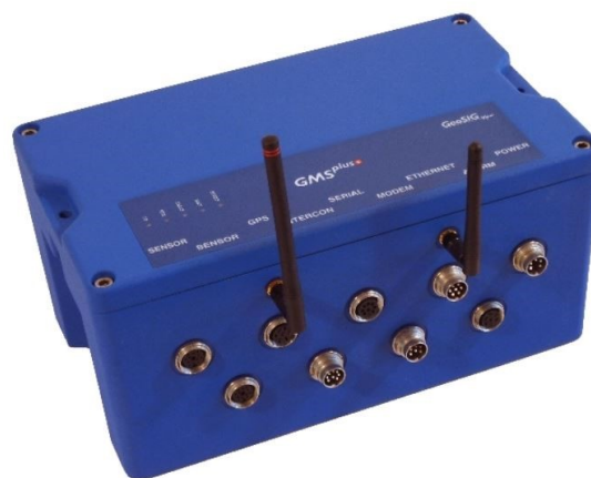
Abbildung 43: GeoSIG GMSplus Messsystem zur Erfassung der Schwinggeschwindigkeiten und Frequenzen der Erschütterungen; Quelle: geosig.com
