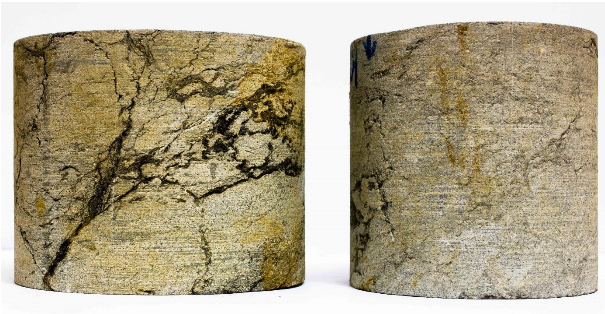
Abbildung 29: Bohrkernabschnitte der Spatkalk Schichten zur Entnahme der Plugs
