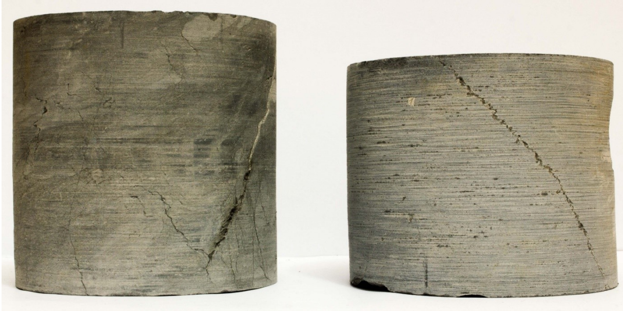
Abbildung 26: Bohrkernabschnitte des Gerstenhübelkalkes zur Entnahme der Plugs
