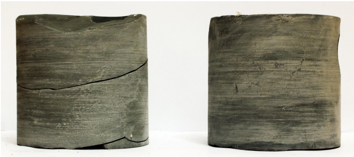
Abbildung 25: Bohrkernabschnitte der Oberen Effinger Schichten zur Entnahme der Plugs
