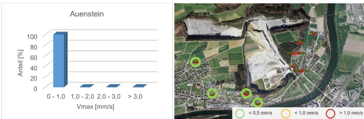
Abbildung 57: Erschütterungscharakteristik der Messstationen in Auenstein
