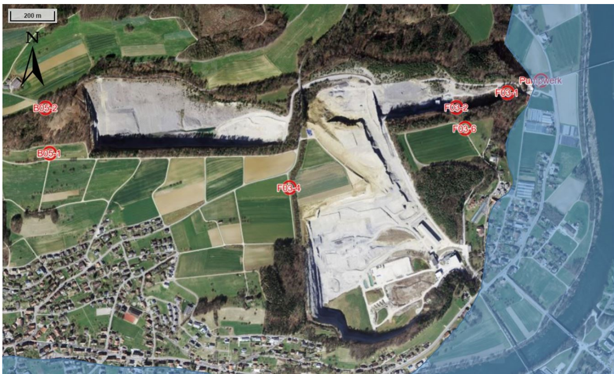
Abbildung 23: Messstellen zur Erfassung der Wasserpegel und Ausdehnung der grundwassergesättigten Lockersedimente (hellblaue Flächen)
