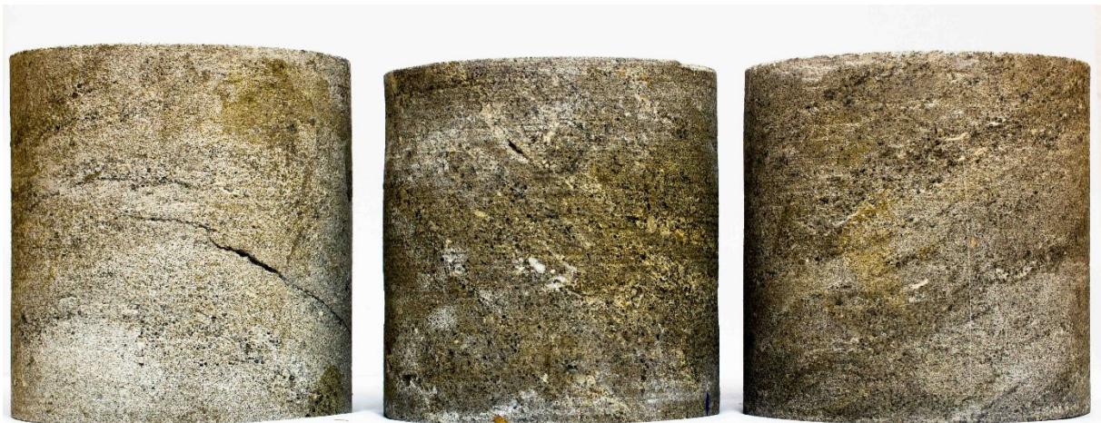
Abbildung 31: Bohrkernabschnitte des Hauptrogensteines zur Entnahme der Plugs
