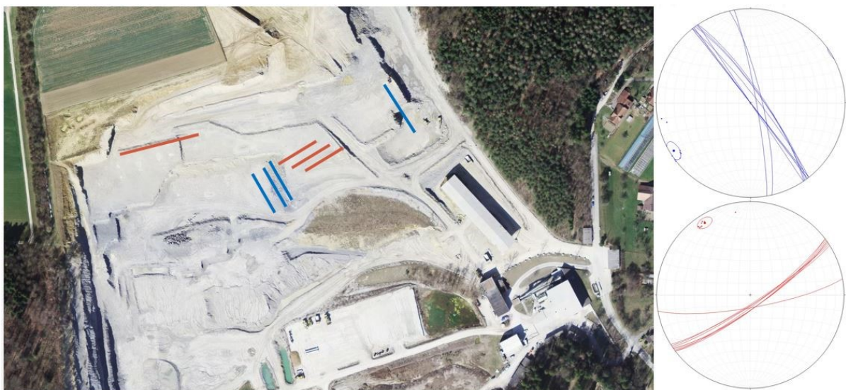
Abbildung 74: Position und Raumlage der ausgewerteten Bruchwände im Satellitenbild und Schmidtschen Netz
