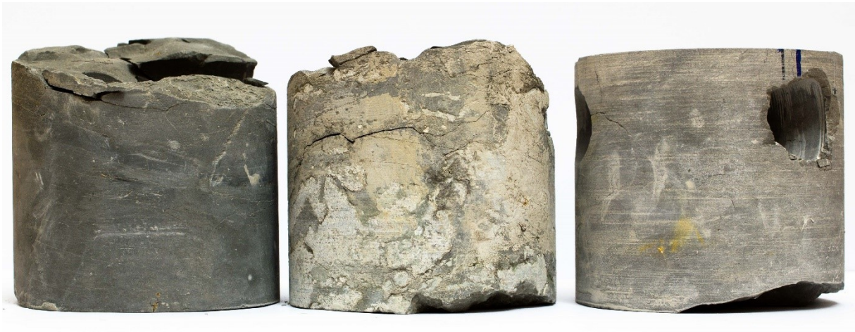
Abbildung 27: Bohrkernabschnitte der Unteren Effinger Schichten zur Entnahme der Plugs
