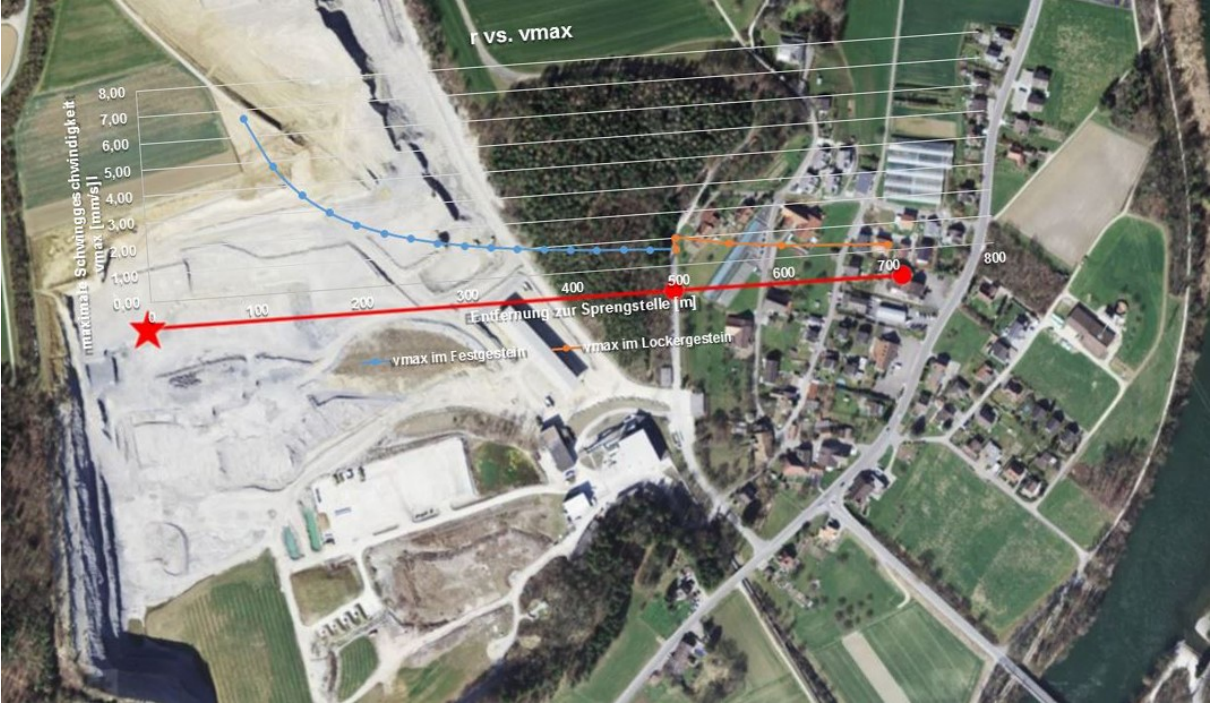
Abbildung 82: Prognostizierte Maximalamplituden einer Sprengung in den Oberen Effinger Schichten
