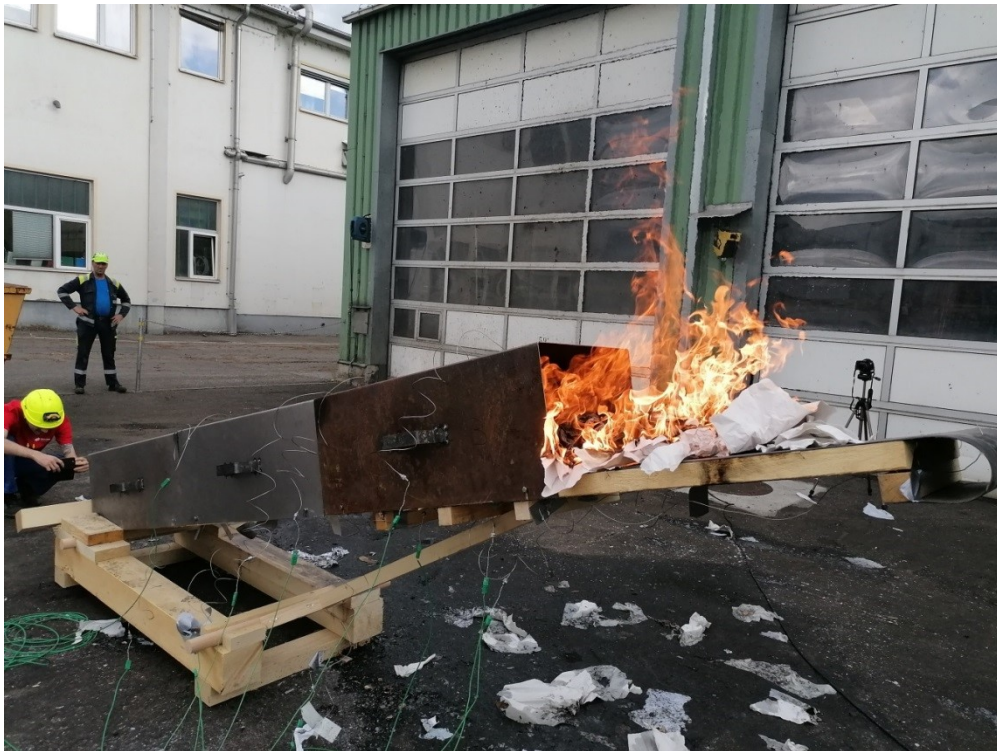
Abbildung 91 Austritt der Flammen nach Einhausung
