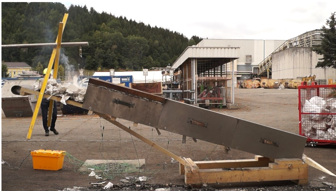
Abbildung 98 Ausströmen der Brandgase am Ende des Tunnels
