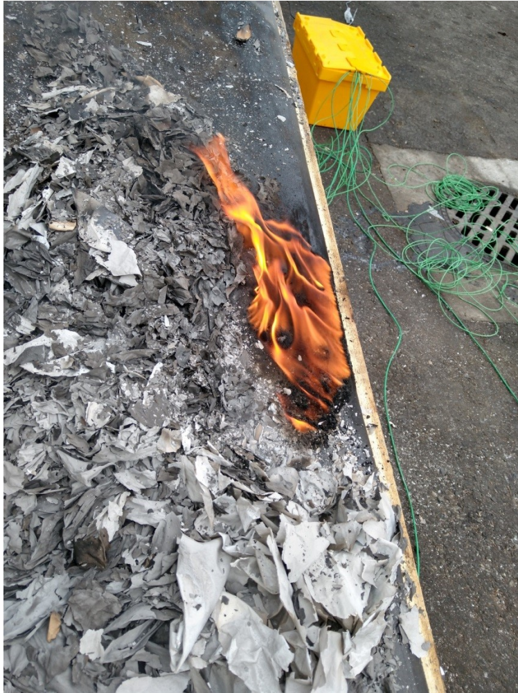
Abbildung 83 Entzündung des Fördergurtes
