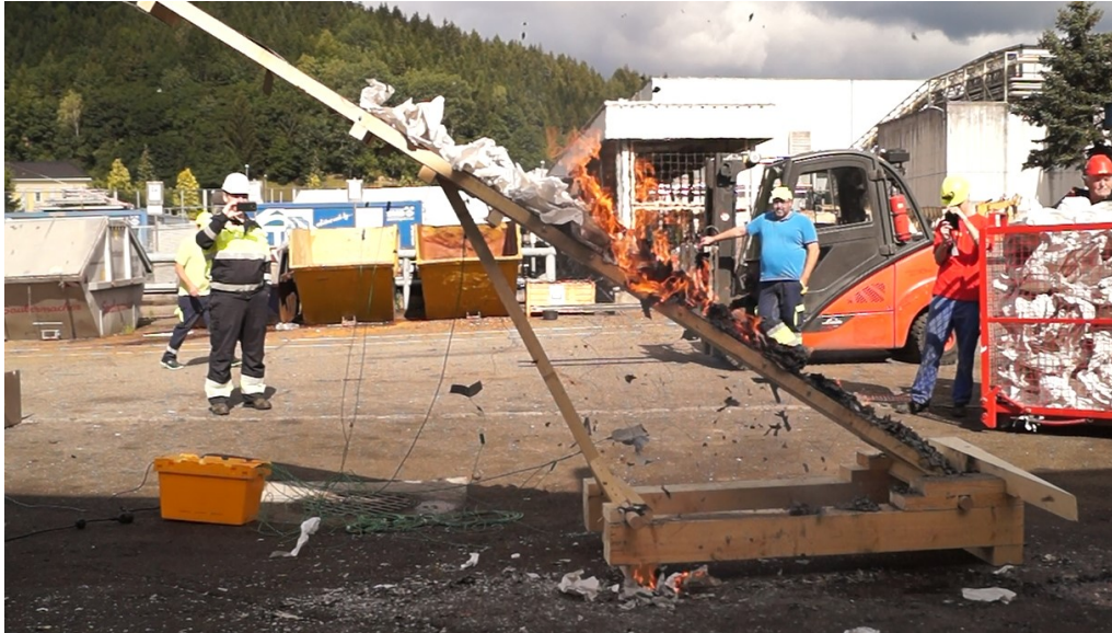
Abbildung 90 Anlegen der Flammen bei 35° Neigung
