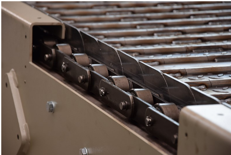
Abbildung 25 Detail Kettenförderer Quelle: GEPE-Technik
