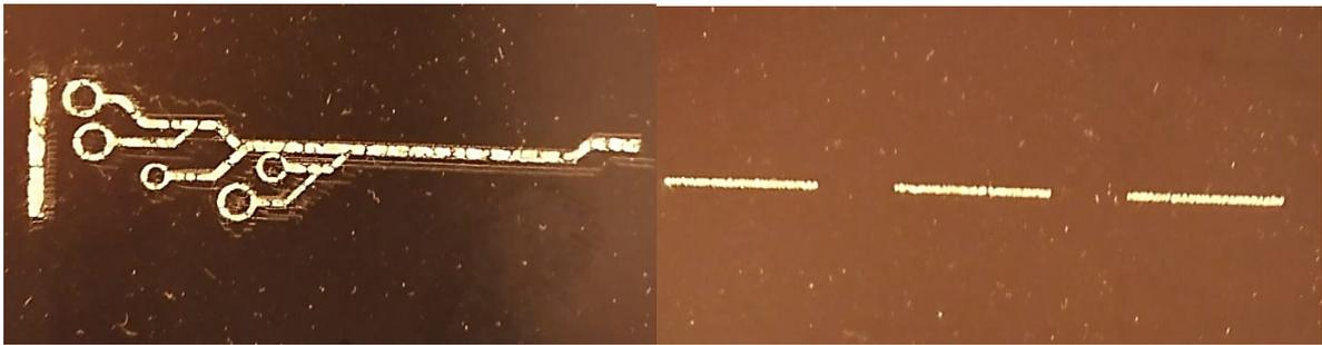
Abbildung 86: Druckergebnisse auf dem schwarzen, beschichteten Substrat.
