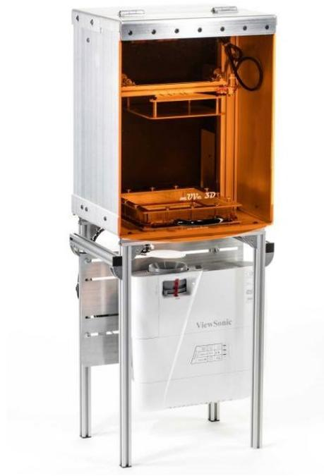
Abbildung 47: mUve 3D DLP Testdrucker.
