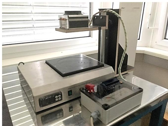
Abbildung 68: Nachhärtungs Apparatur mit Heizplatte.
