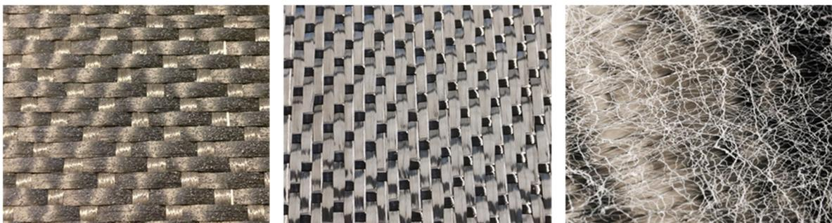
Abb. 4: Bebinderte Textilien von links nach rechts: Pulver bebindert, eigewobener Binder mittels Comingling und Hotmelt-Sprühbinder.
