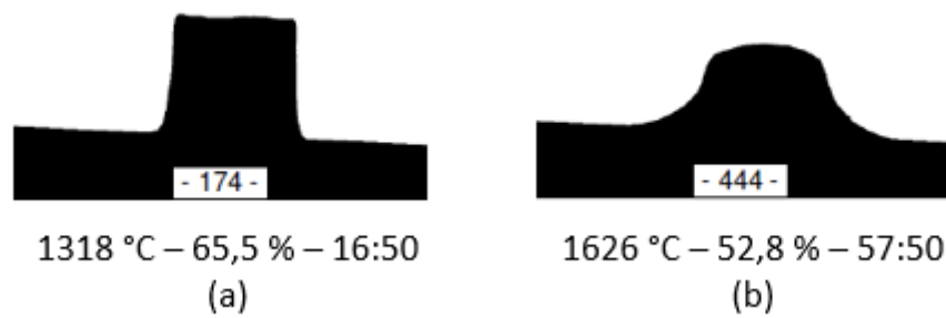
Abbildung 42 a & b: Querschnitt bei NMC am Erweichungspunkt (a) und am letzten Messpunkt der Messung (b)
