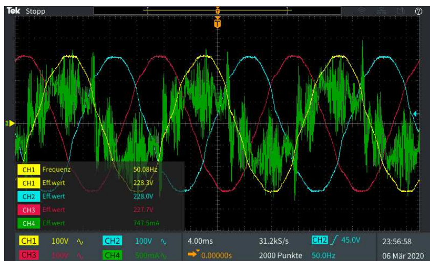
Abbildung 5-14: Wechselrichter AC-Strommessung – Oszilloskop Zeitverlaufsplot
