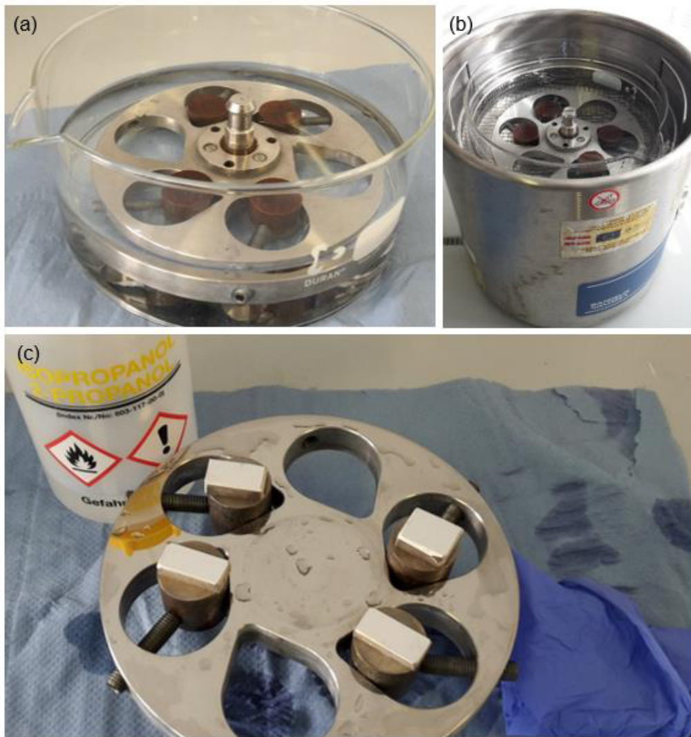
Abbildung 22: Vorgehensweise im Anschluss zum Polierschritt: (a) Probenhalter samt Proben eingelegt in einem Ethanolbad; (b) Ultraschallbehandlung; (c) Entfernung des restlichen OPS-Rückstands mithilfe eines Gummihandschuhs und Isopropanol
