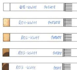
Abb. 4: Ozontest, Gasphase der Reaktorenabläufe
