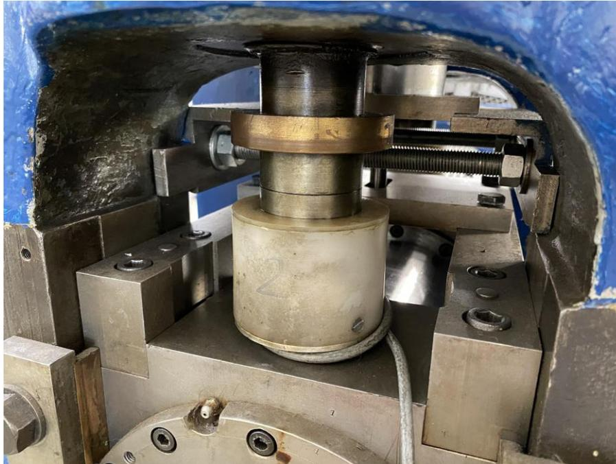
**Abb. 25:** Kraftmessdose 2 des Walzwerks
