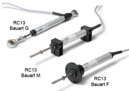
Die Serie RC13 in Schutzart IP60 wird in Applikationen eingesetzt, die eine Wegsensor mit einseitig geführter Schubstange mit Messlängen von 25 bis 250 mm benötigen. Die drei Bauarten erschließen ein breites Anwendungsfeld.
