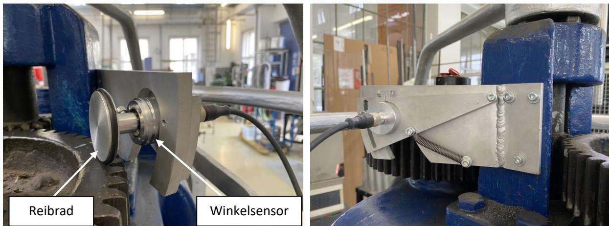
**Abb. 58:** Montage des Winkelsensors
