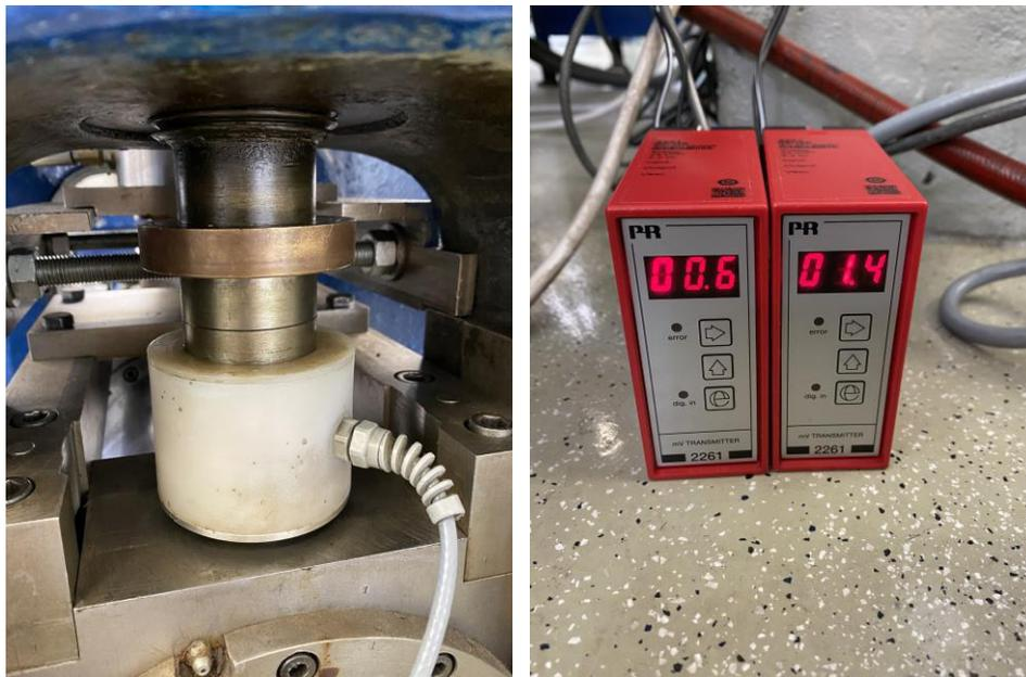
**Abb. 60:** Kraftmessdose (links) und die beiden mV-Transmitter der Kraftmessdosen (rechts)
