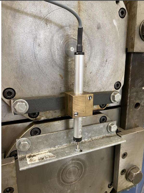
**Abb. 56:** Montage des Linearpotentiometers
