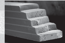
Erhöhung der Bruchenergie durch stufenweisen Bruchverlauf
