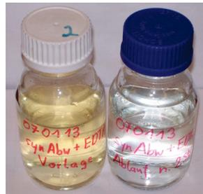
Abb. 3: Laborversuchsanlage mit Anodischer Oxidation (links), Prototyp der Ozonierungseinheit (mitte), optischer Vergleich unbehandeltes synthetisches Abwasser mit behandeltem (rechts).
