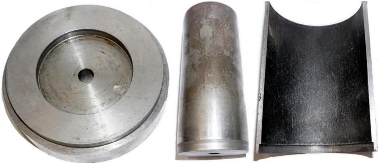
Abbildung 20: Einzelteile der Gussform
