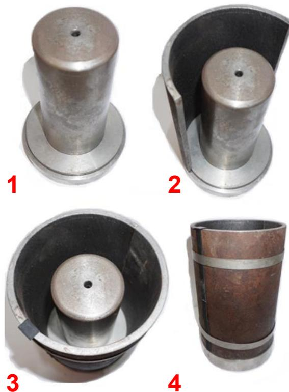
Abbildung 21: Schrittweiser Zusammenbau
