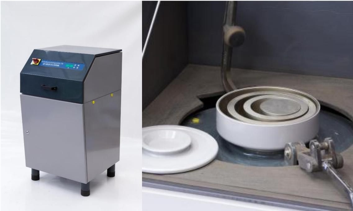
Abbildung 23: Scheibenschwingmühle TS1000 von außen und innen [43]
