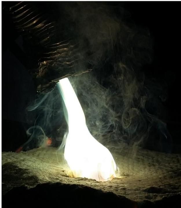
Abbildung 37: Flamme der Reoxidation von Zink zu Zinkoxid
