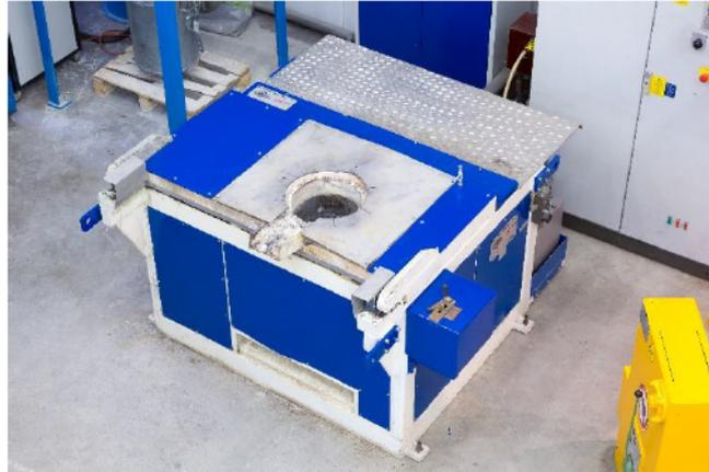
Abbildung 34: Induktionstiegelofen [43]
