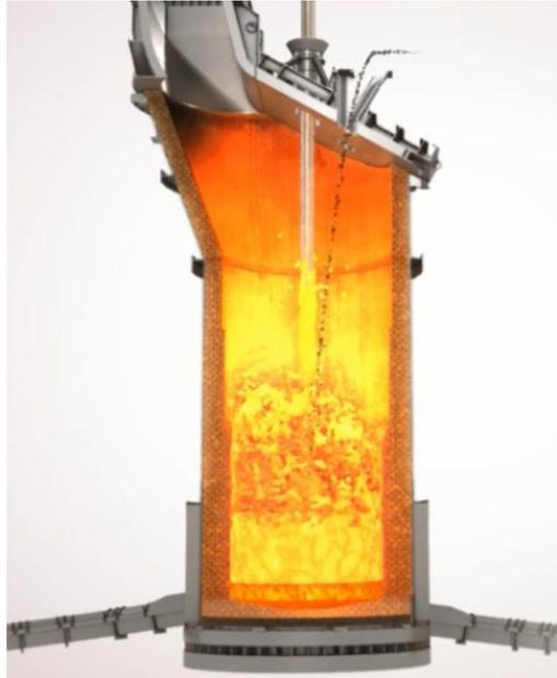
Abbildung 11: Ausmelt-Konverter [30]
