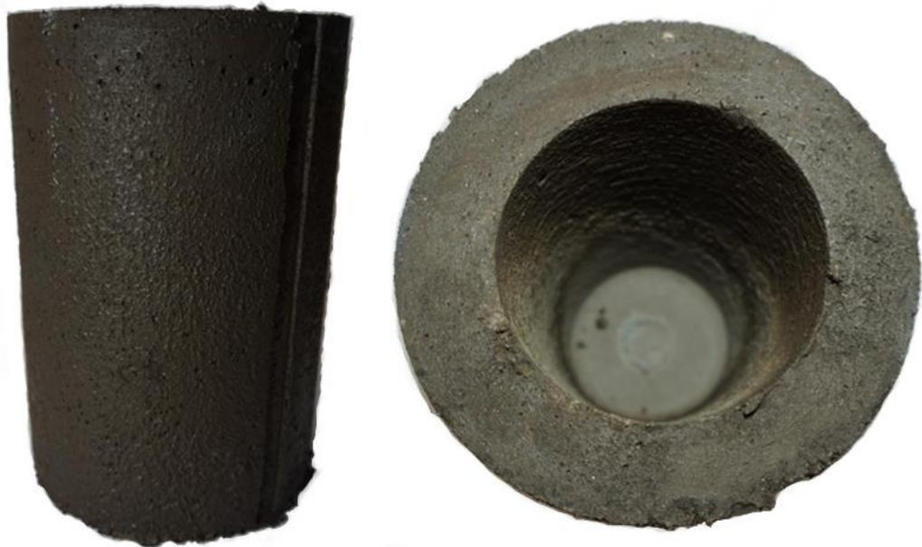
Abbildung 22: Hydratisierter Tiegel
