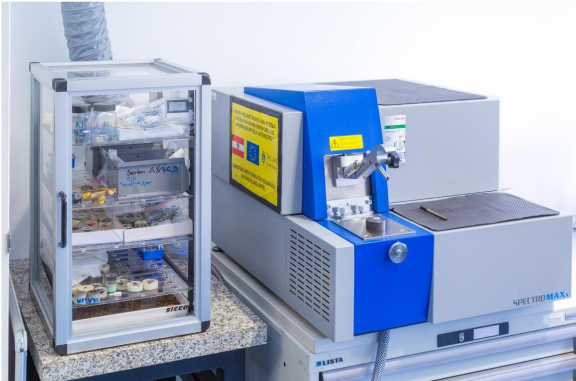
Abbildung 24: Funkenspektrometer der Firma SPECTROMAXx [43]
