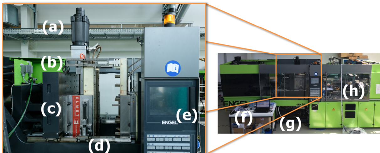
Abbildung 15: Spritzgießmaschine mit RubExject-Werkzeug; (a) Elektromotor, (b) Führungselemente, (c) auswerferseitige Aufspannbacke, (d) zusätzliche horizontale Führung, (e) Bedieneinheit, (f) Arbeitsplatz für Messtechnik, (g) Freiraum für Temperierschläuche, (h) Spritzeinheit mit streifenförmigen Material.
