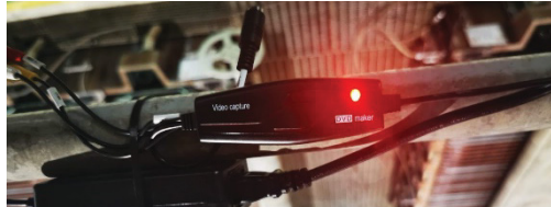
Abbildung 4-2: USB-Video Grabber zur Umwandlung des analogen Thermobildes in ein digitales
