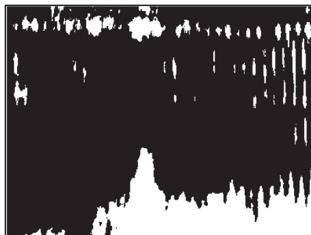
Abbildung 4-16: Maskierung für den blauen Farbbereich einer Thermoaufnahme in der Kupferraffinationselektrolyse
