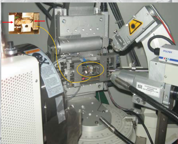
„In-situ“-Druckversuch für Röntgenfeinstrukturuntersuchungen an der Piezokeramik
