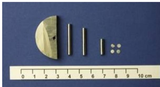
**Abbildung 27:** Aus dem Rohmaterial wurden Zylinder mit 3mm Durchmesser gefertigt und danach Plättchen mit einer Dicke von 200 µm geschnitten.
