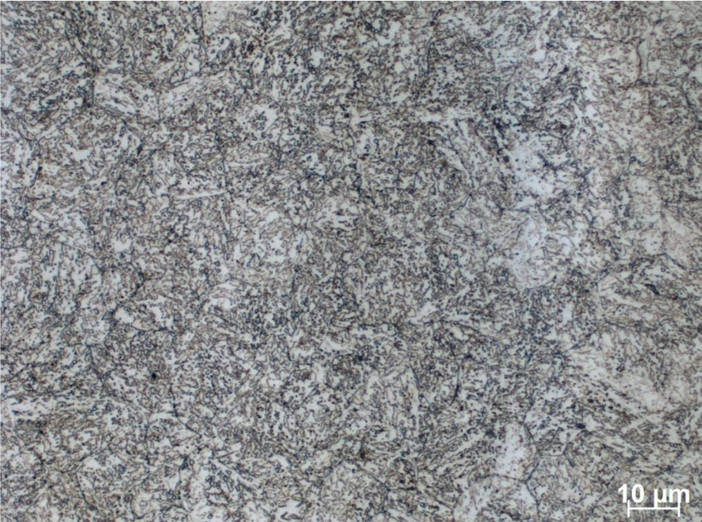
Abbildung 65: Bainitisches Gefüge des Stabmaterials bei  $\lambda 10$ .
