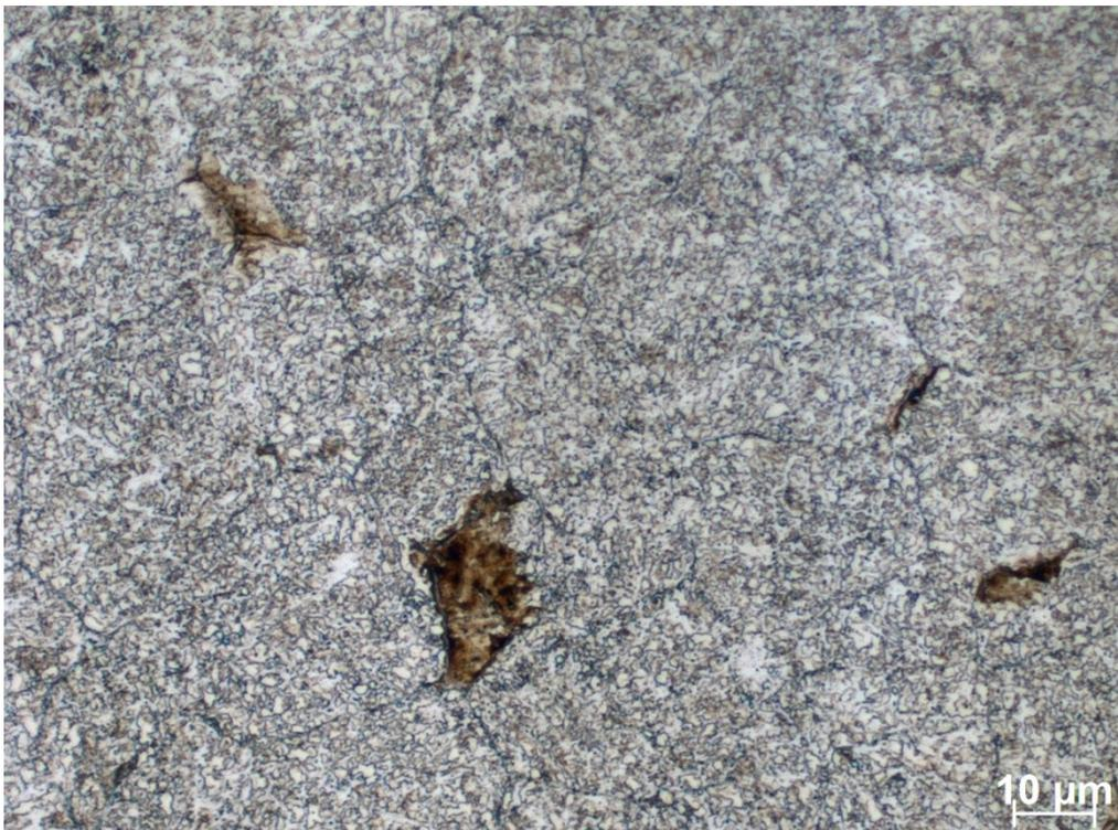
Abbildung 67: Bainitisches Gefüge mit Perlit des Stabmaterials bei  $\lambda 18$ .
