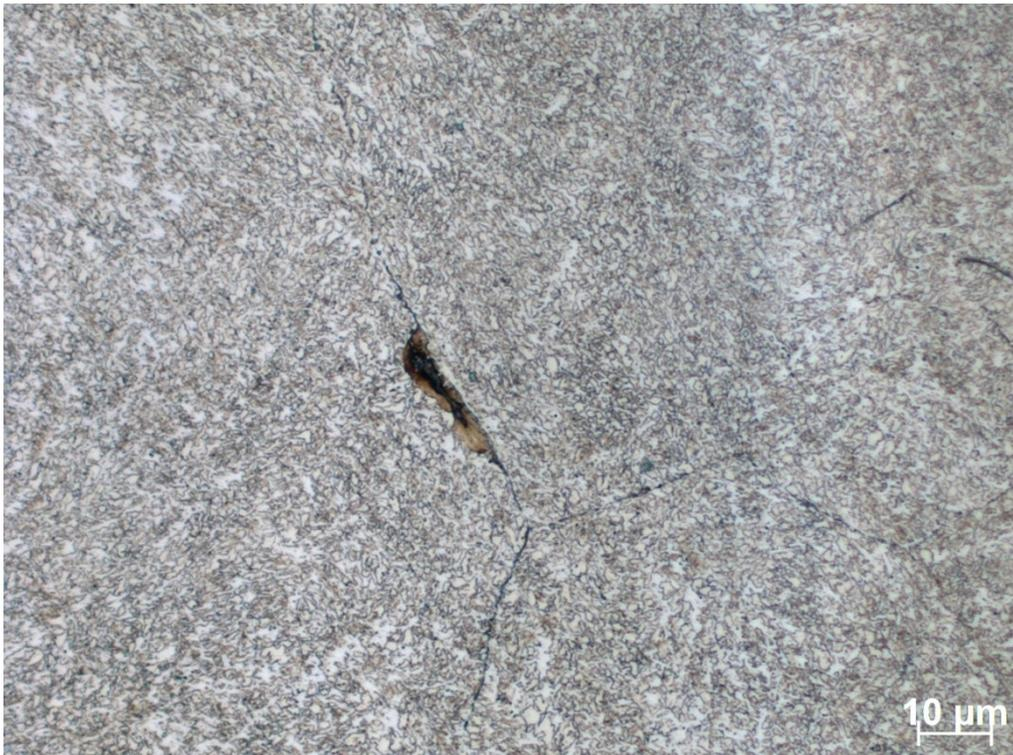
Abbildung 66: Bainitisches Gefüge mit erster Perlitbildung des Stabmaterials bei  $\lambda 14$ .
