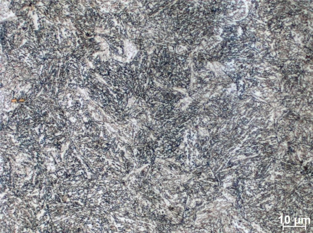
Abbildung 64: Bainitisches Gefüge des Stabmaterials bei  $\lambda 4$ .
