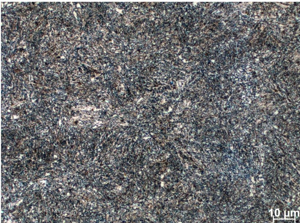
Abbildung 63: Bainitisches Gefüge des Stabmaterials bei  $\lambda 2$ .
