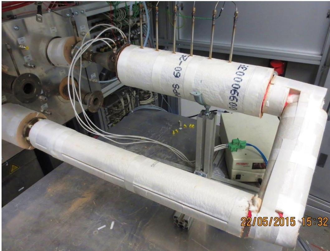
Abbildung 17: glühender Startbrenner am Puma - Prüfstand
