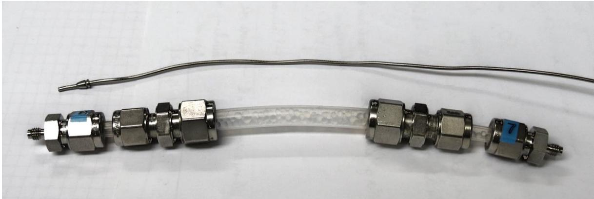
Abbildung 32: oben Messgasleitung 1/16“, unten Zwischenstück mit Silikagel
