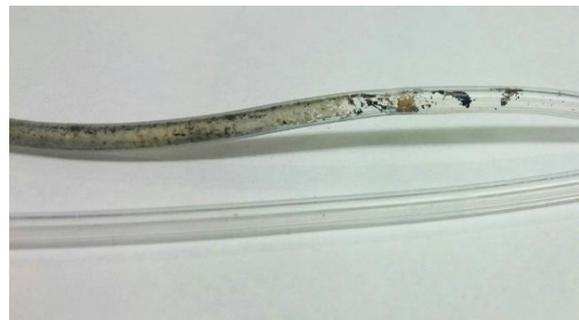
Abbildung 34: GC-Pumpe Schlauch alt/neu
