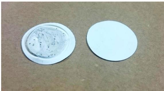
Abbildung 33: GC-Pumpe Membran alt/neu
