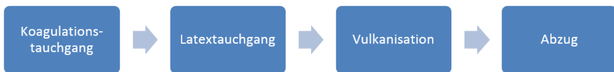
Abbildung 4: Schematische Darstellung eines Koagulationstauchprozesses
