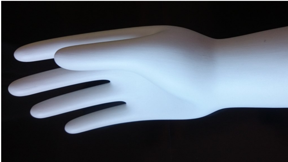
Abbildung 3: Handform aus Keramik, verwendet für die Herstellung von Latexhandschuhen im Koagulationstauchprozess
