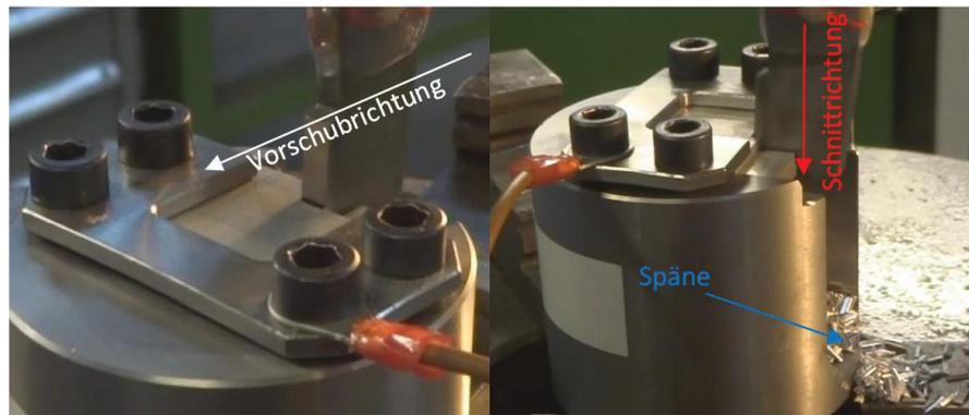
Abbildung 14) Stoßversuch [39]
