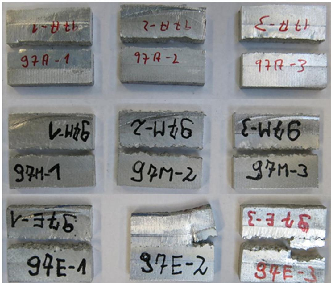
Abbildung 81) Fotodokumentation Zugversuch VGM97
