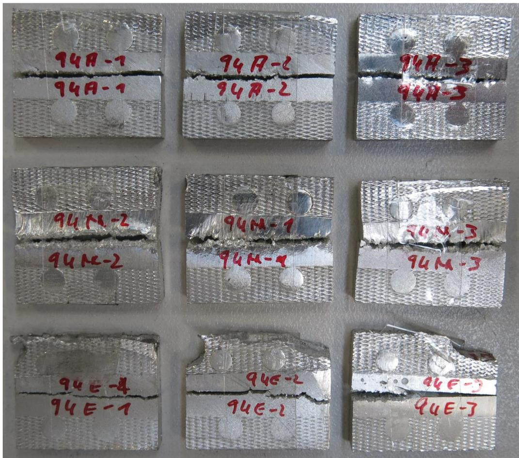
Abbildung 75) Fotodokumentation Zugversuch VGM94
