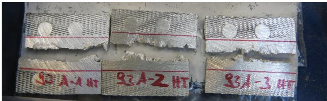
Abbildung 37) Zugversuch 2. Versuchsreihe
