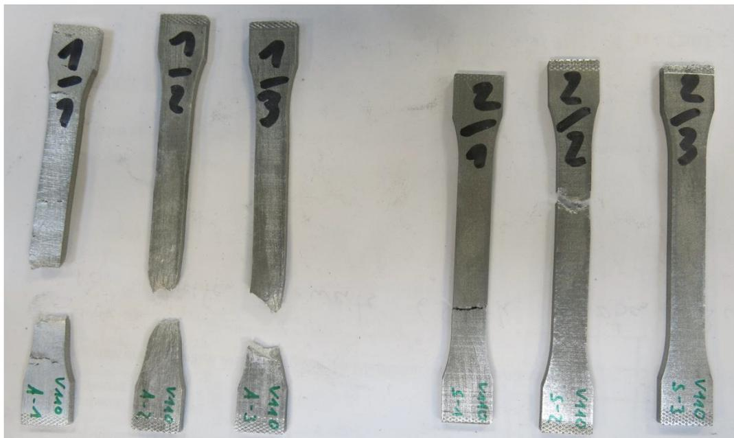
Abbildung 124) Fotodokumentation Zugversuch Komponenten V110
