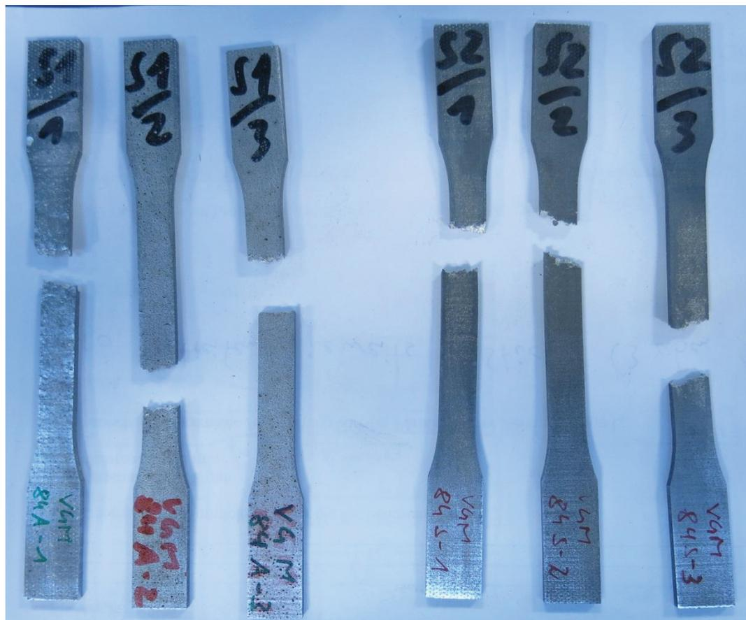
Abbildung 120) Fotodokumentation Zugversuch Komponenten VGM84
