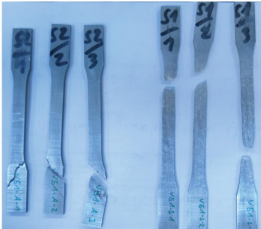
Abbildung 122) Fotodokumentation Zugversuch Komponenten V51
