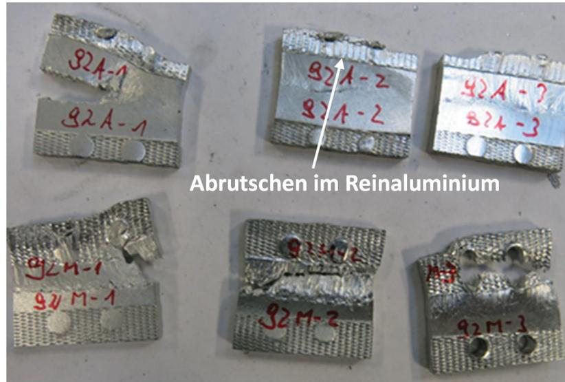
Abbildung 35) Zugversuch 1. Versuchsreihe
