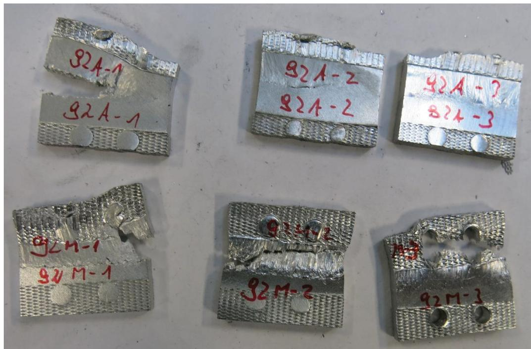
Abbildung 71) Fotodokumentation Zugversuch VGM92
