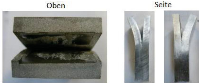
Abbildung 42) Fotodokumentation Wedge-Test V70-1
