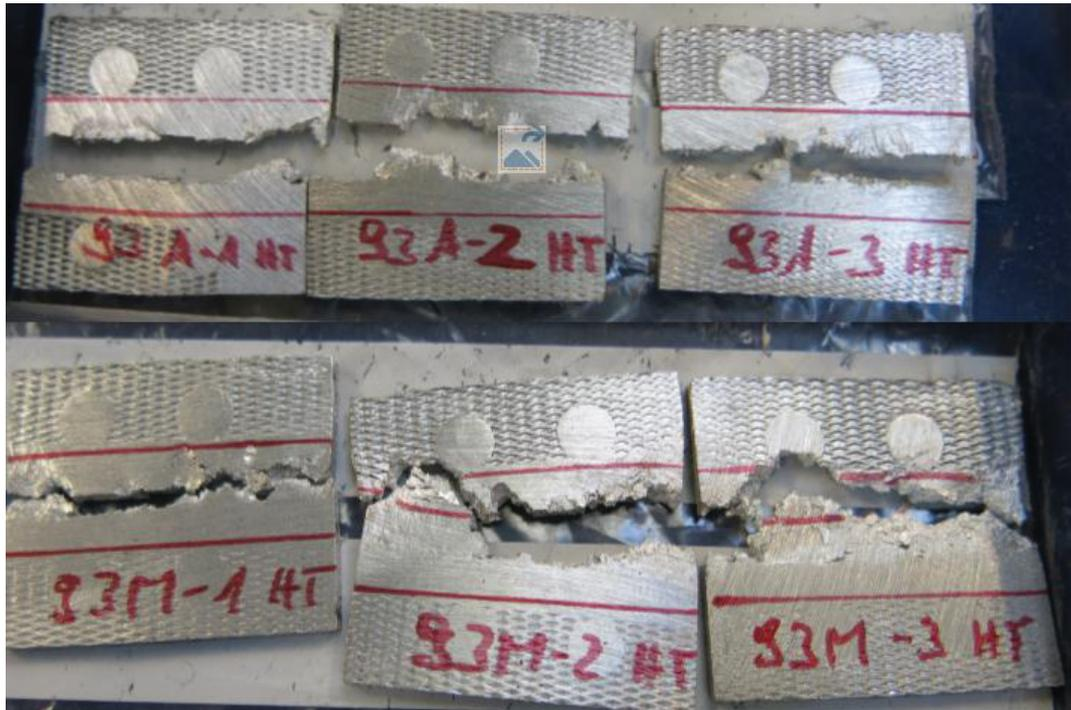
Abbildung 89) Fotodokumentation Zugversuch VGM93\_HT
