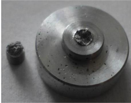
Abbildung 39) Bruchbild Zentrifugentest VGM84-2 [39]
