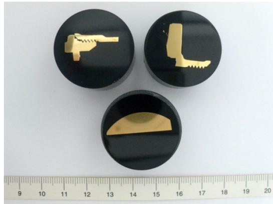
Abbildung 56: Übersicht der metallographischen Schlitze des Ventils I
