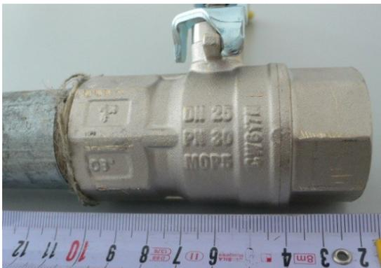
Abbildung 47: Referenzventil (Ventil II), verbunden mit Stahlrohr
