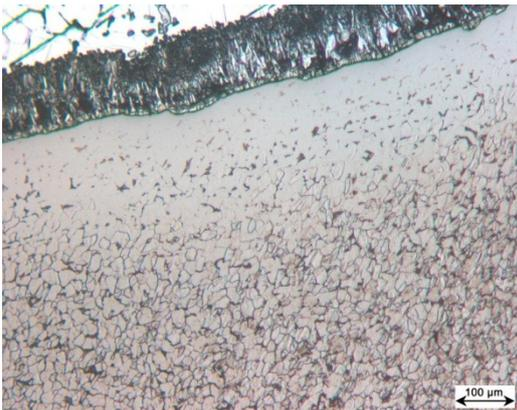
Abbildung 130: Serie I, Längsschliff, Ferrit und Perlit, Innenradius
