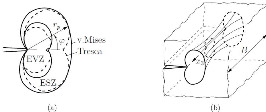
Abbildung 2.2.: Plastische Zone a) Größenvergleich von ESZ zu EVZ b) in einer dicken Platte, üblicherweise als Hundeknochenmodell bezeichnet [1]
