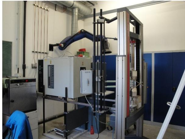
Abbildung 40: Zwick/Roell Material-Prüfmaschine Allround-Line 100 kN inklusive Temperaturkammer (-80 °C bis 300 °C) [43]
