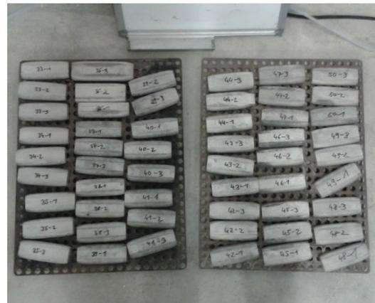
Abbildung 37: Proben nach Stauchung und Abtrennung der Härteproben
