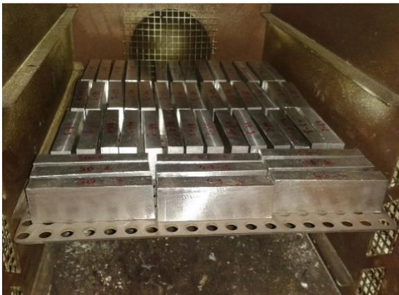
Abbildung 36: Homogenisierung der geteilten Blöcke für die Stauchung
