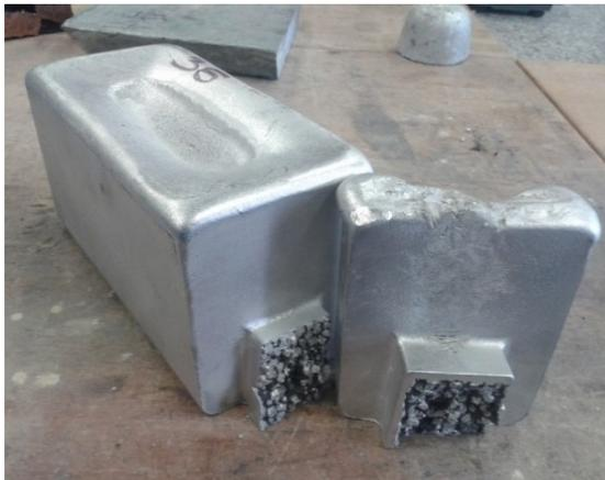
Abbildung 32: Gussblock und abgeschlagener Einguss im Rohzustand
