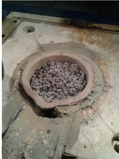
Abbildung 31: Stark verkrätzte Schmelzbadoberfläche aufgrund von Magnesiumabbrand
