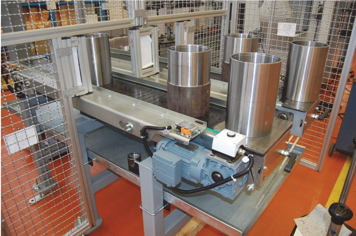
Abb.: 87 Fertigteile am Ende des Förderbandes
