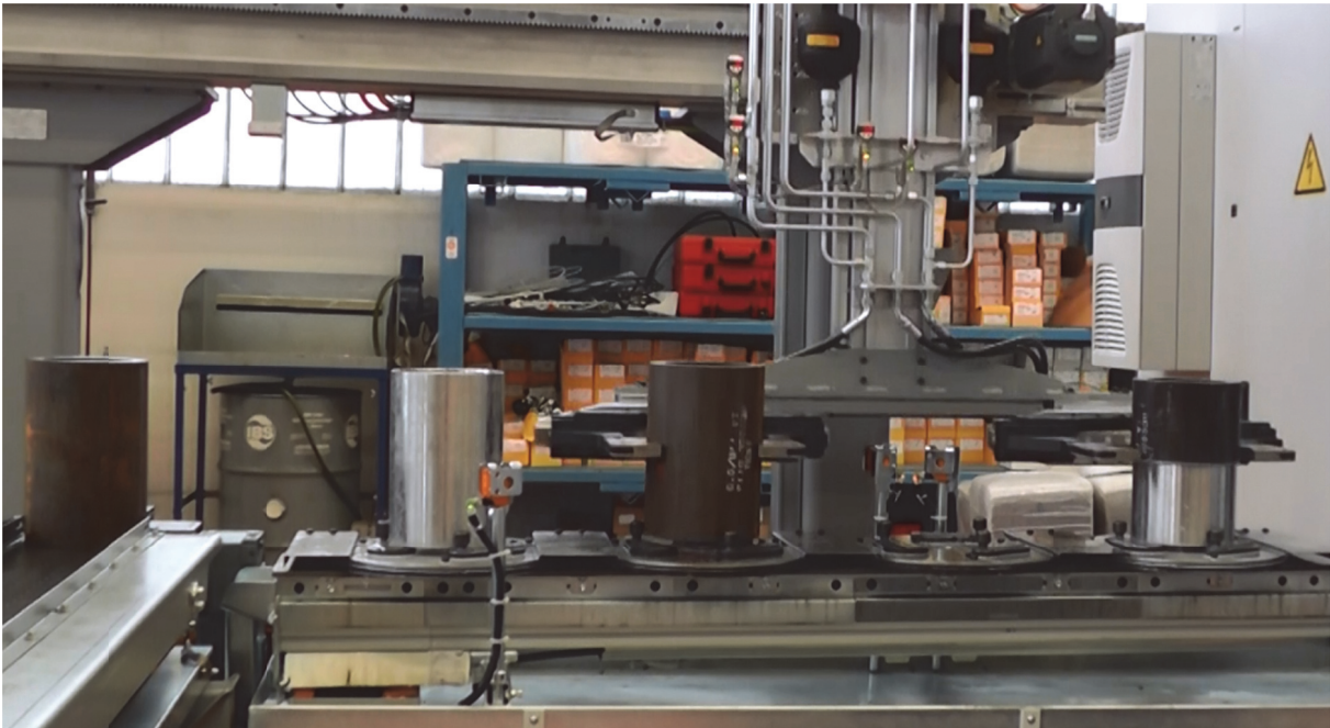
Abb.: 85 Portalkran beim Aufsetzen des Rohlings
