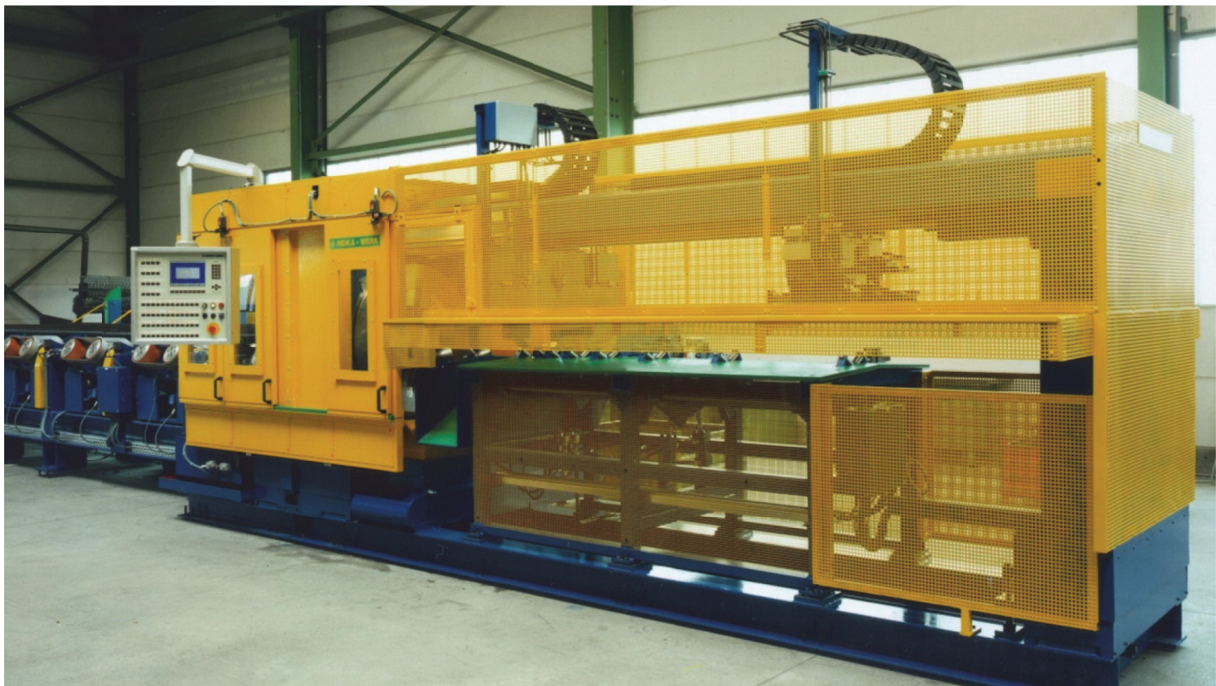
Abb.: 54 Reika Rohrabstechmaschine
