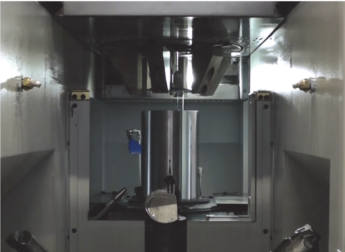
Abb.: 86 Aufnahme des Rohlings durch ein Sechs-Backenfutter
