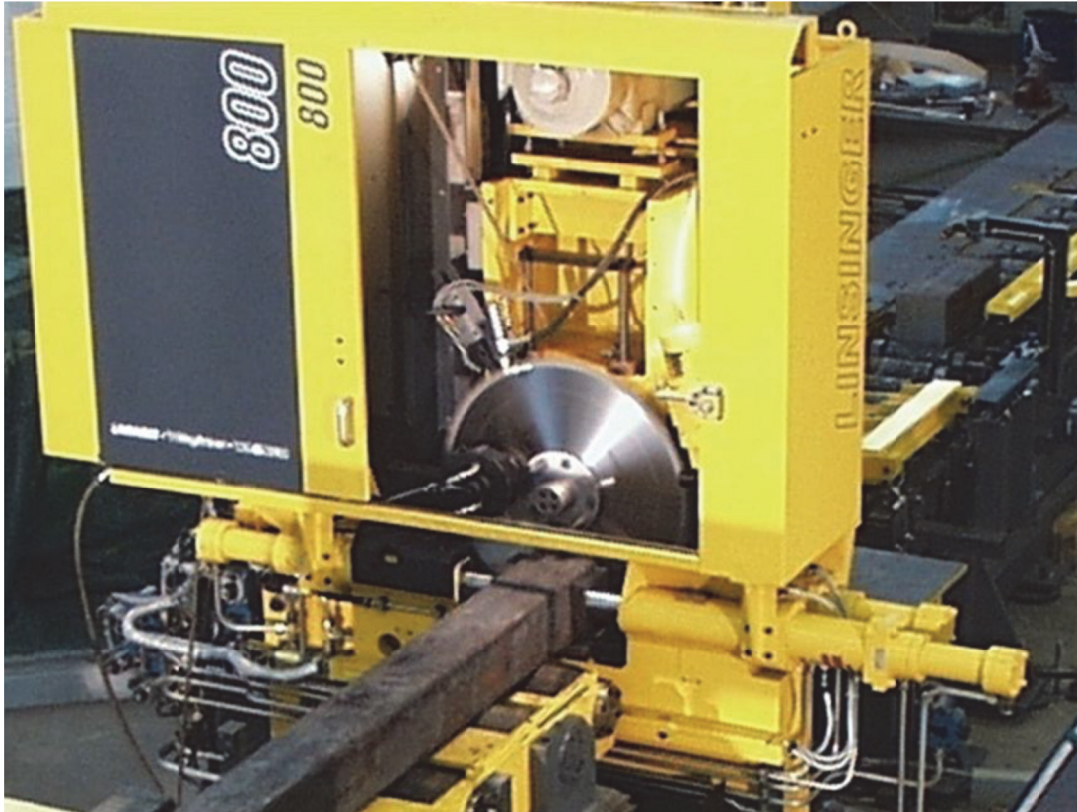
Abb.: 49 Hochleistungskreissägeanlage KSA 800 (Quelle: Linsinger)
