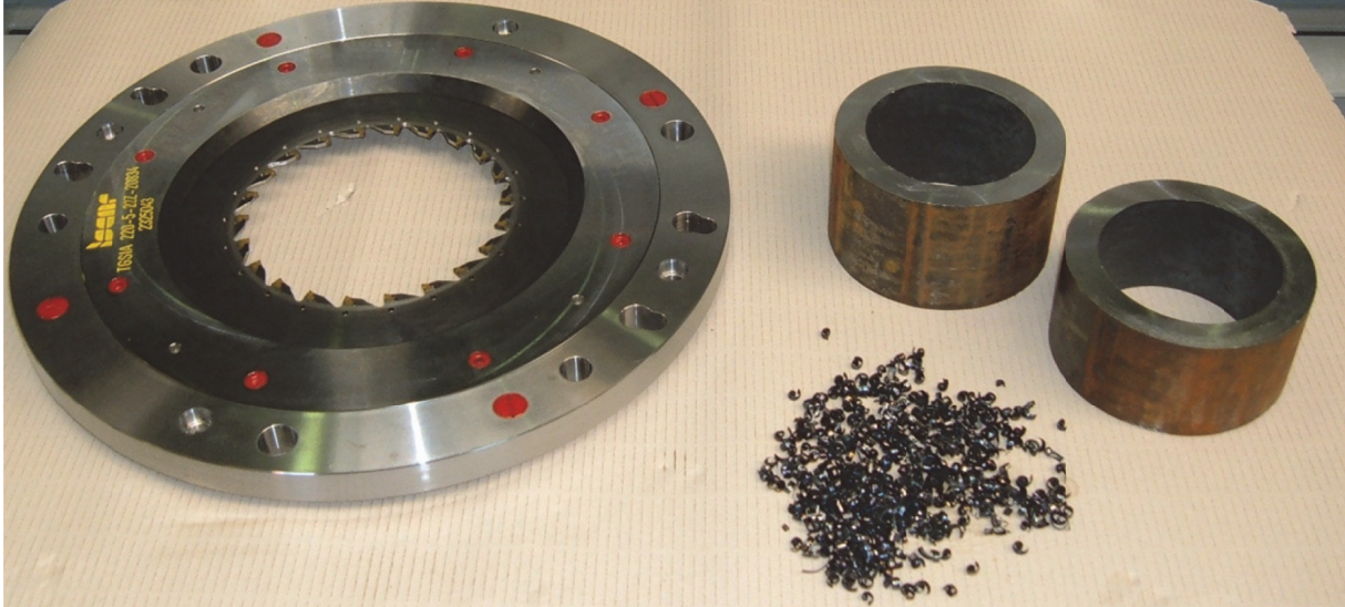
Abb.: 49 Ring Saw Trennwerkzeug mit Standard-Schneideinsätzen (Quelle: Reika)
