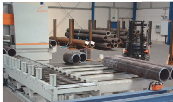
Abb.: 37 Schnittbereiche einer Bandsägeanlage
