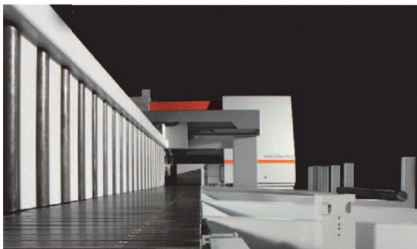
Abb.: 37 Schnittbereiche einer Bandsägeanlage
