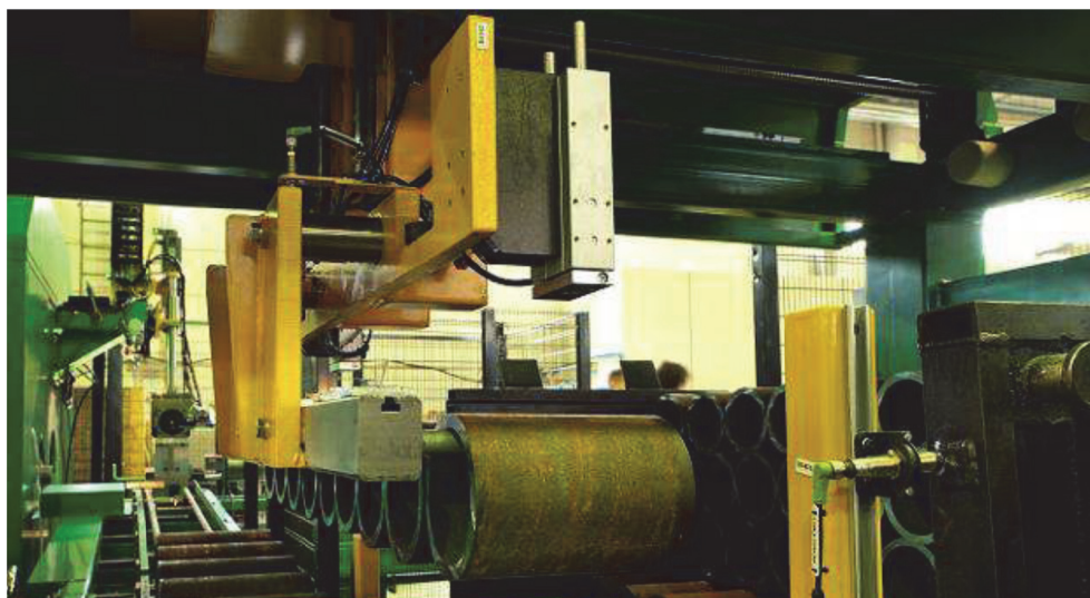
Abb.: 73 Greifarm mit den gereihten Muffenrohlinge
