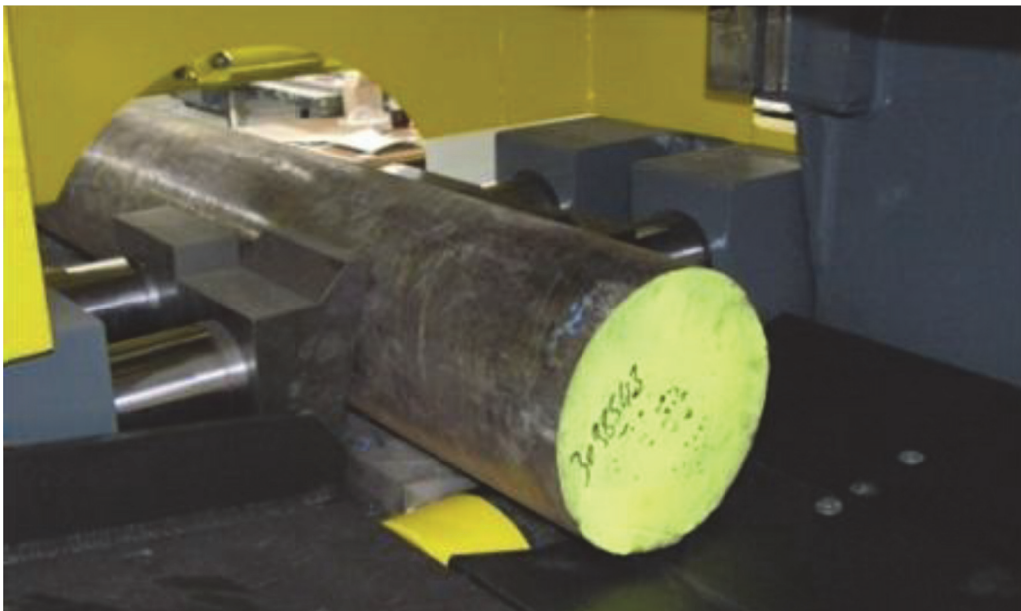
Abb.: 50 Spanneinrichtung KSA 800 (Quelle: Linsinger)
