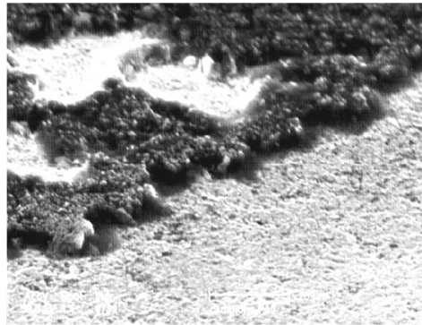
Abbildung 5.4: Durch \text{NaMnO}_4 und \text{H}_2\text{SO}_4 gebildete schwarze Oxidschicht auf einer Hartmetalloberfläche [64]
