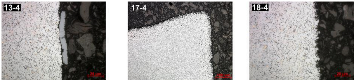
Abbildung 7.8: Lichtmikroskopaufnahme von ausgesuchten Schliffen der mit \text{Al}_2\text{O}_3 beschichteten Wendschneidplatten
