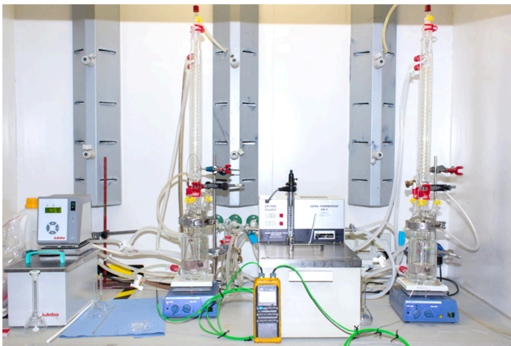
Abbildung 6.7: Versuchsanordnung zur Entschichtung jeweils einer Wendeschneidplatte
