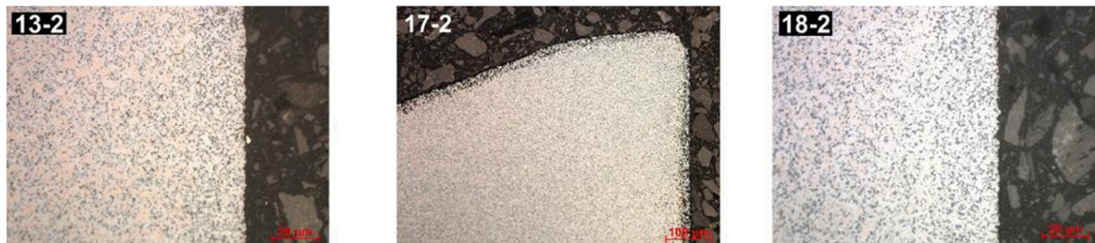
Abbildung 7.6: Lichtmikroskopaufnahme von ausgesuchten Schliffen der mit TiAlTaN beschichteten Wendschneidplatten
