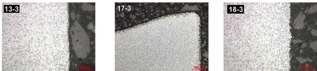
Abbildung 7.7: Lichtmikroskopaufnahme von ausgesuchten Schliffen der mit TiB 2 beschichteten Wendschneidplatten
