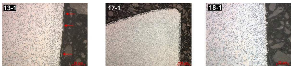
Abbildung 7.5: Lichtmikroskopaufnahmen von ausgesuchten Schliffen der mit TiAlN beschichteten Wendeschneidplatten
