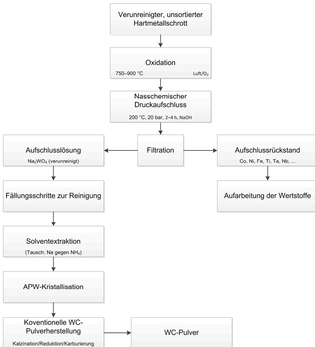
Abbildung 3.5: Flussdiagramm zur Hartmetallaufbereitung mittels oxidativem Prozess und nasschemischem Aufschluss [13]
