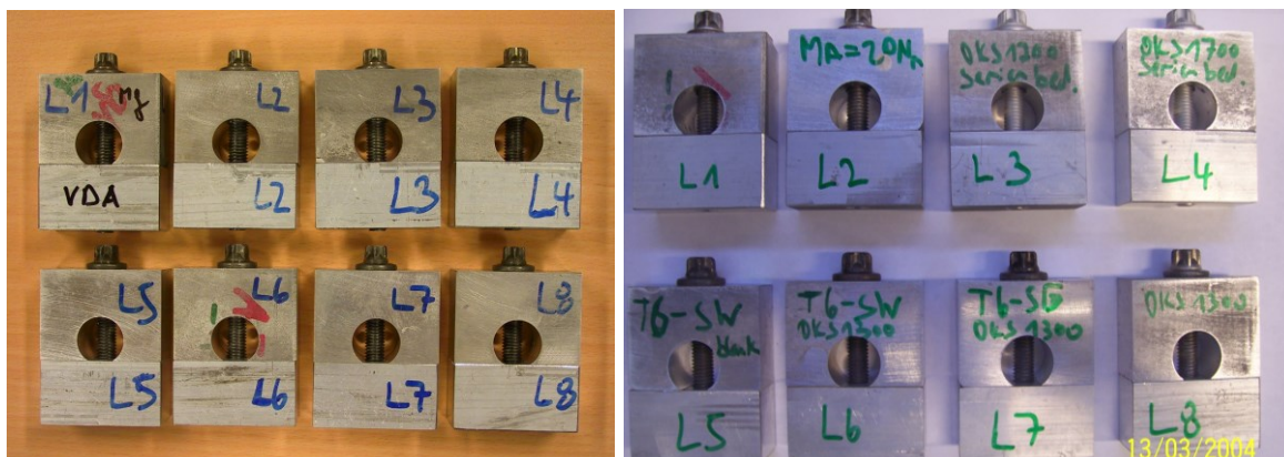
Abbildung 69: a) Prüfkonzept Mg TT2k ® EN AW 7075 von 2004 b) TT2k ® von Jan. 2008
