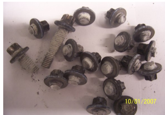
Abbildung 51 a) Nach 100 h SpRK-Test Drehmomentenverlauf beim Lösen b) Schraubenbrüche
