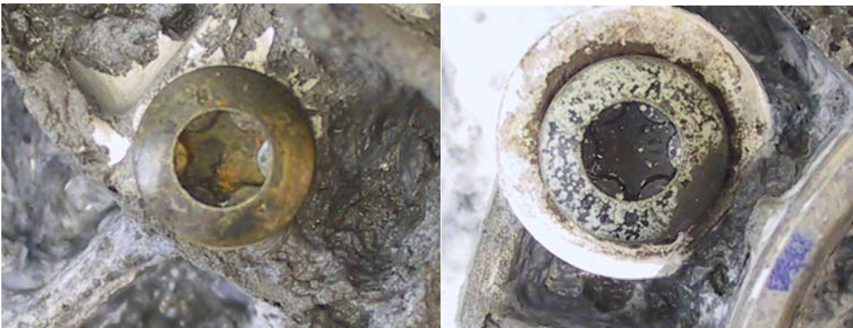
Abbildung 32 a): M8 - 8.8 + DeltaTone DeltaSeal b): M8 - 8.8 + D.Tone D.Seal + AlMg3-Scheibe
