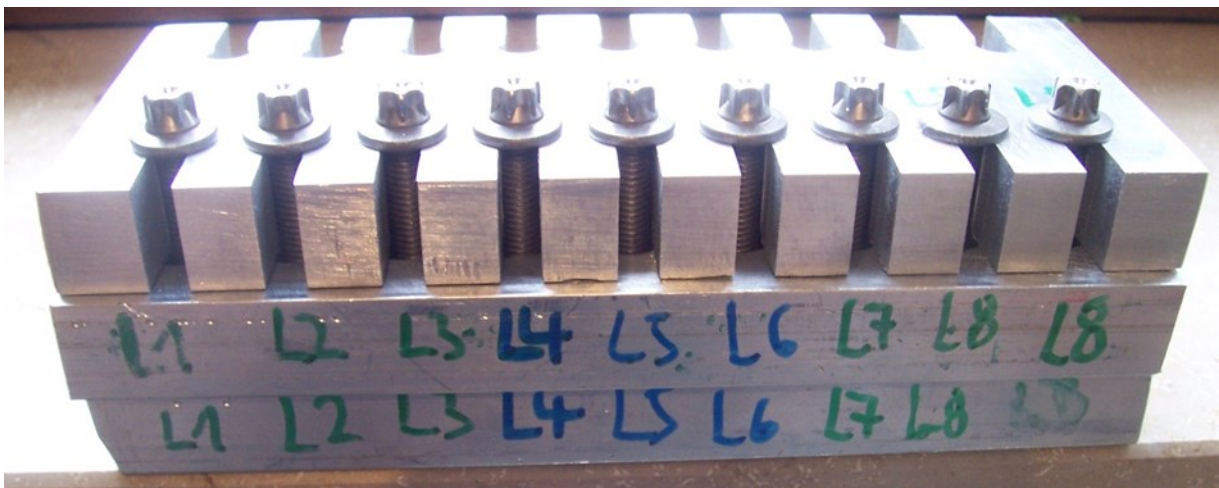
Abbildung 82: Prüfkonzept AI-Block - 80°C nach der Montage der 3 Prüfplatten
