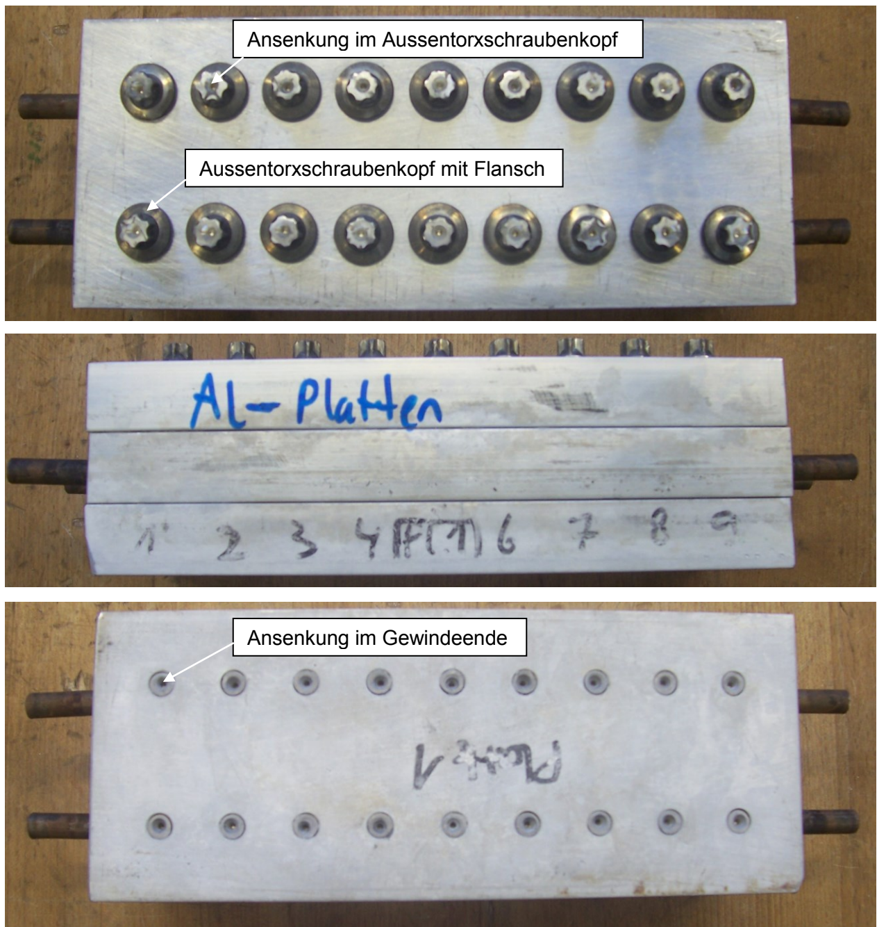
Abbildung 57: AlMgSi 0,5 -Platten (oben Draufsicht, Mitte Seitenansicht, unten Unteransicht)
