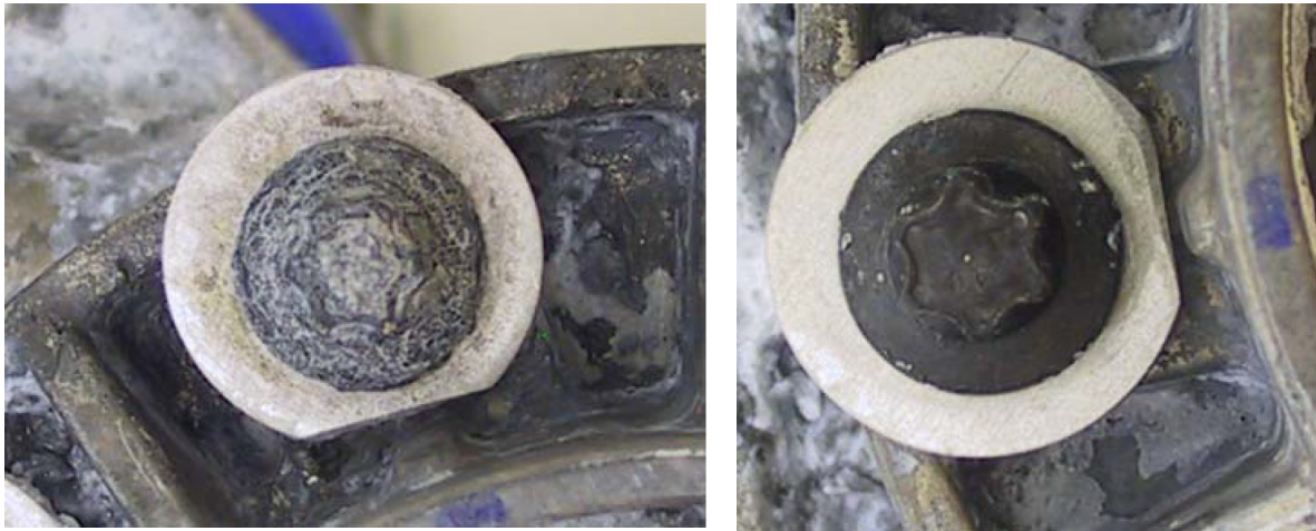
Abbildung 27 a) EN AW 7075 + AlMg3-Scheibe b) EN AW 7075 + Delta Seal + AlMg3-Scheibe
