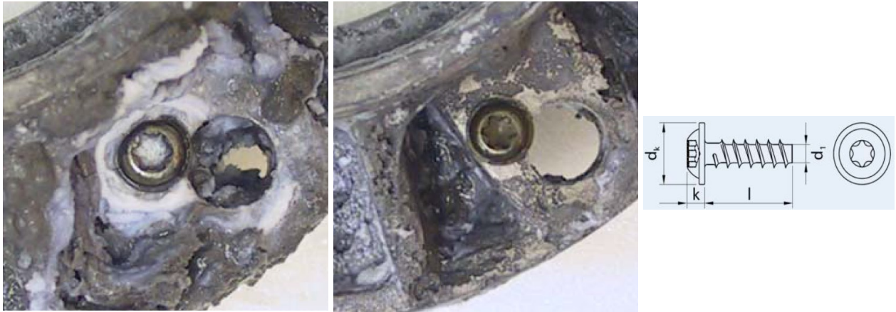
Abbildung 33 a): REMFORM ® 4 x 14 b): REMFORM ® nach Reinigung c): Prinzipskizze REMFORM ®
