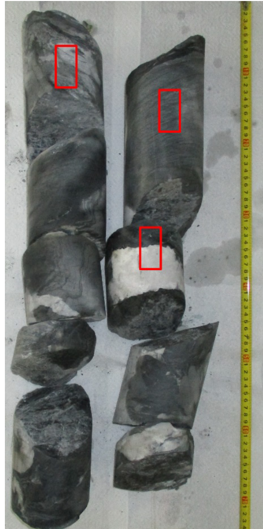
Abbildung 83: Kernmaterial OBS 1, Dünnschliffe wurden aus dem rot umrandeten Bereich hergestellt.
