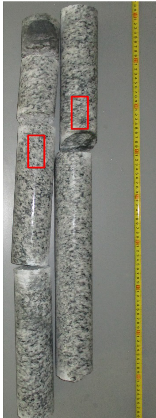
Abbildung 174: Kernmaterial MG, Dünnschliffe wurden aus dem rot umrandeten Bereich hergestellt.
