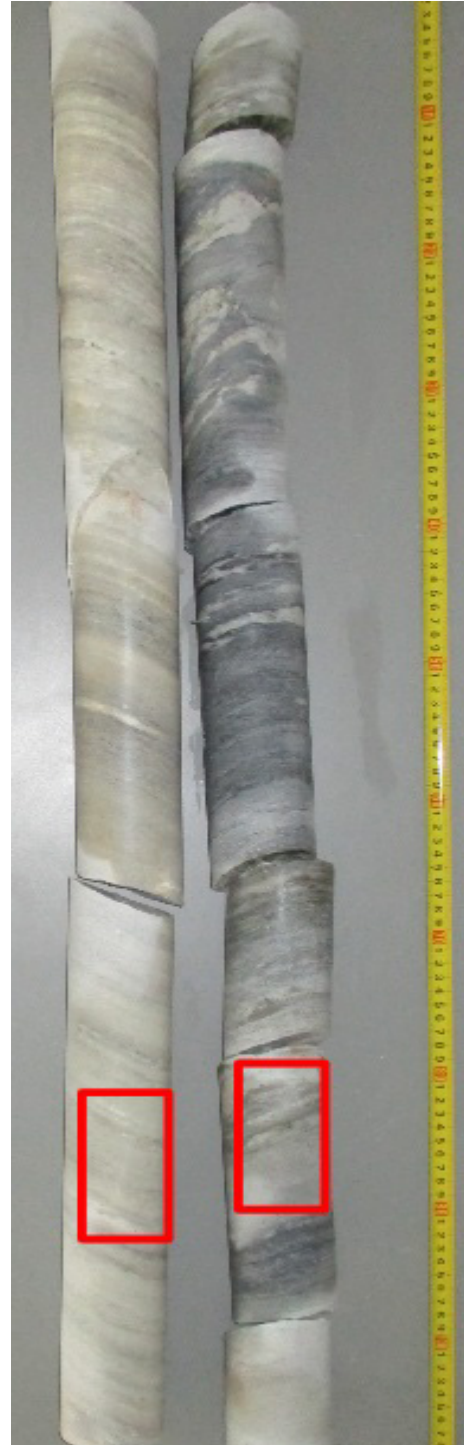
Abbildung 121: Kernmaterial HM 1, Dünnschliffe wurden aus den rot umrandeten Bereich hergestellt.
