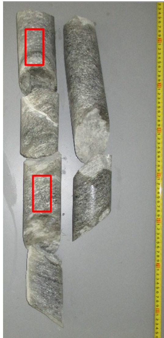
Abbildung 155: Kernmaterial TO, Dünnschliffe wurden aus dem rot umrandeten Bereich hergestellt.
