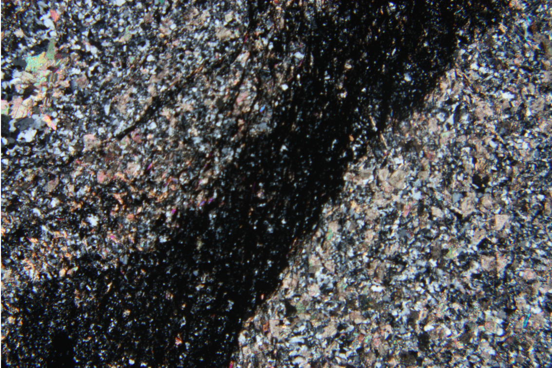
Abbildung 85: Scherband durch das Gestein, BB: 4mm
