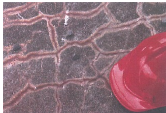
Abbildung 4: Schädigungsmerkmale: a) Bildung eines Geltropfen, FERNANDES ET.AL., 2004 b) Verfärbung der Rissflanken, PALMER FRENCH ET.AL., 1992
