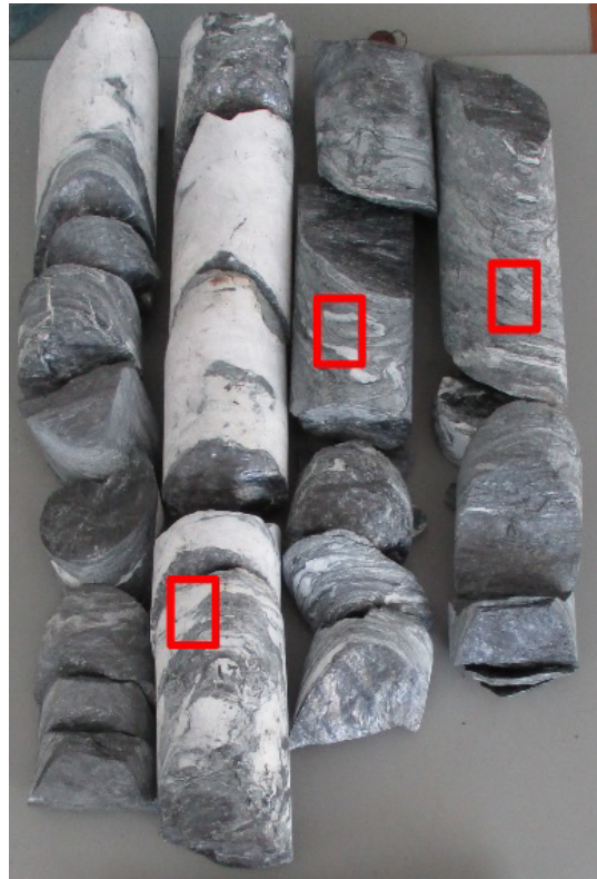
Abbildung 22: Kernmaterial UBS 2, Dünnschliffe wurden aus dem rot umrandeten Bereich hergestellt.
