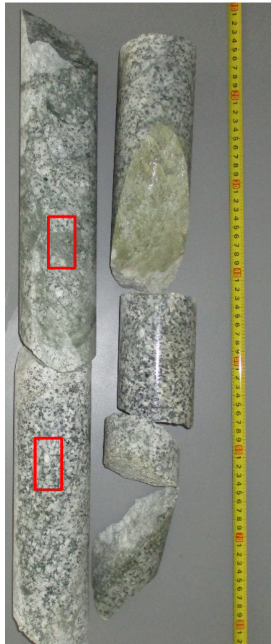
Abbildung 148: Kernmaterial BG, Dünnschliffe wurden aus dem rot umrandeten Bereich hergestellt.
