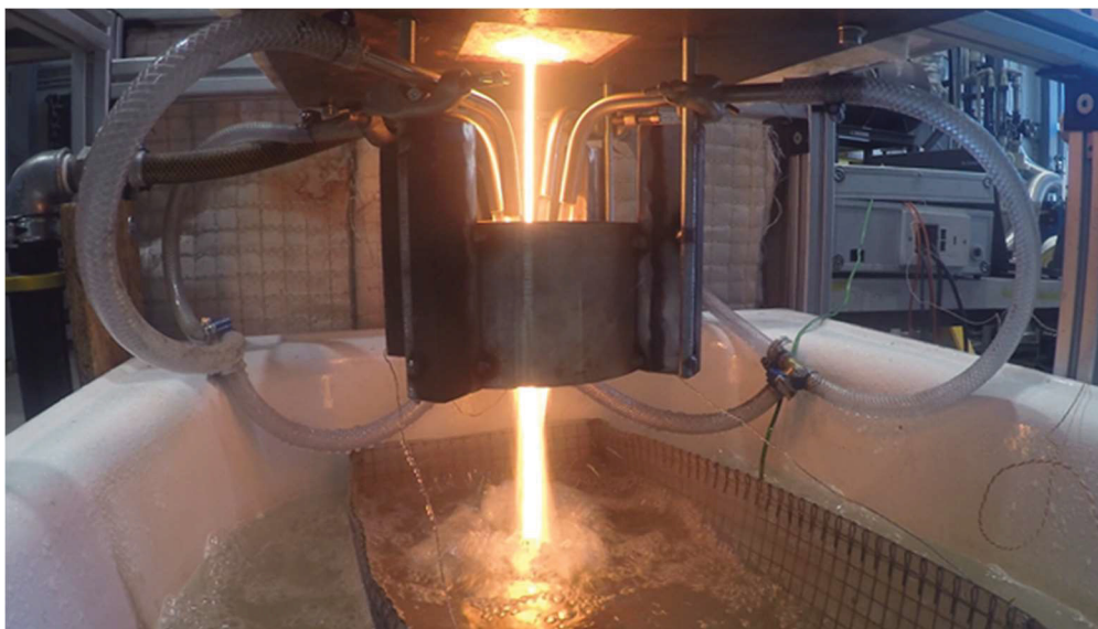
Abbildung 9-4: Düse während des Granulationsvorgangs von WSG19_C02_V01
