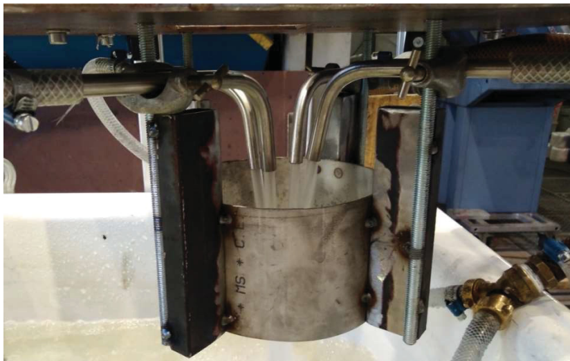
Abbildung 7-3: Vereinfachtes Ringdüsenkonzept WSG19_C02_V01/V02/V03
