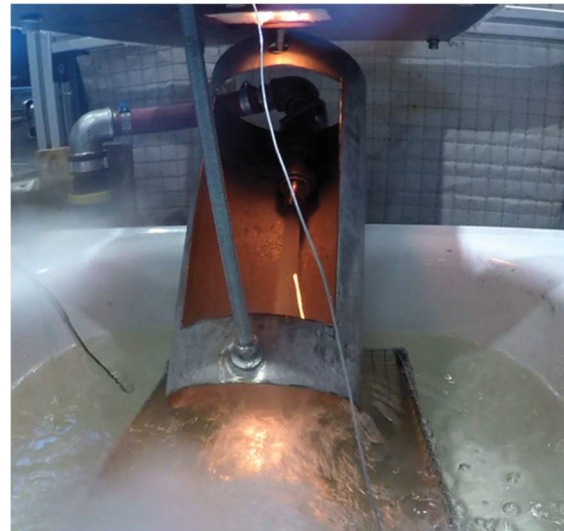
Abbildung 9-3: Rinne gegen Ende des Granulationsvorgangs von WSG19_C01_V02
