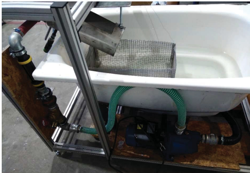
Abbildung 5-14: Aufbau der Wasserkreislaufs mit Granulationsbecken
