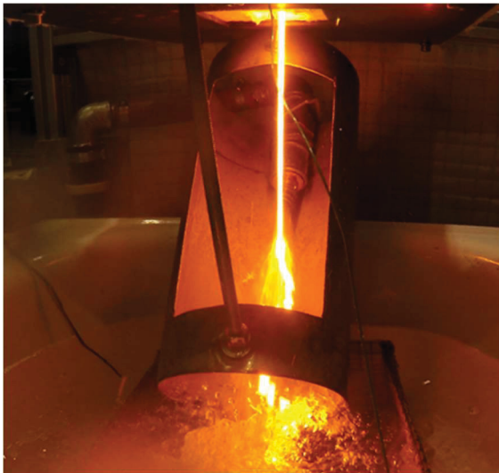
Abbildung 9-2: Rinne während des Granulationsvorgangs von WSG19_C01_V02
