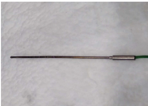
Abbildung 5-9: Temperatursensor (Thermoelement Typ-K))
