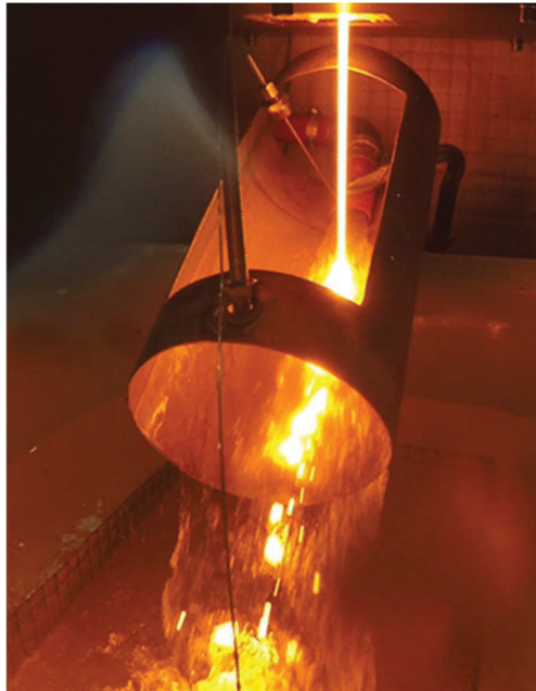
Abbildung 9-1: Rinne während des Granulationsvorgangs von WSG19_C01_V01
