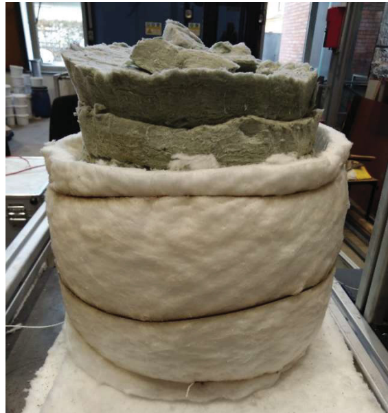
Abbildung 6-5: Isolierung der Schmelzaufbaus nach einem Versuch
