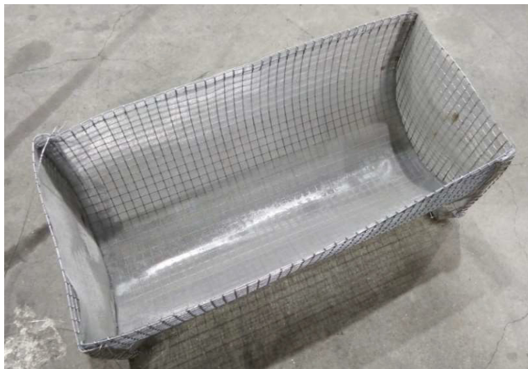
Abbildung 5-13: Auffangsieb für die granulierten Schlacke
