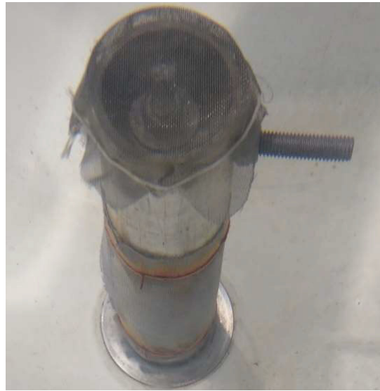
Abbildung 9-6: Filtersieb beim Ausfluss
