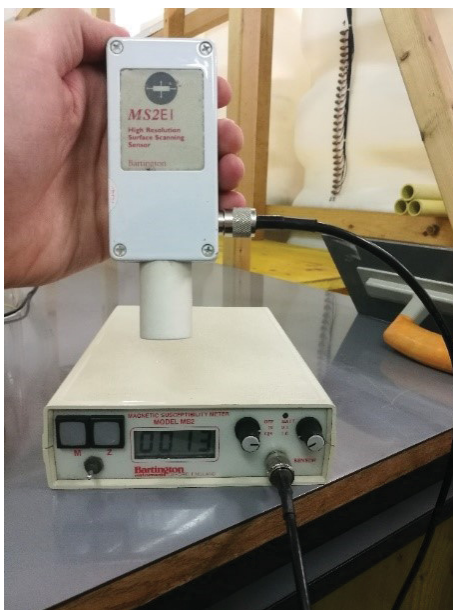
Abb. 3: Bartington MS2 System mit MS2EI Sensor.
