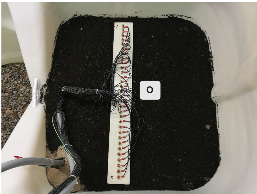
Abb. 14: Versuchskammer mit geringmächtiger Überdeckung durch Blumenerde und Elektrodenreihe O.
