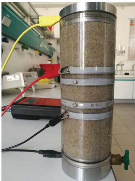
Abb. 5: Zylinder 1 mit Probenmaterial befüllt und vollständig gesättigt.
