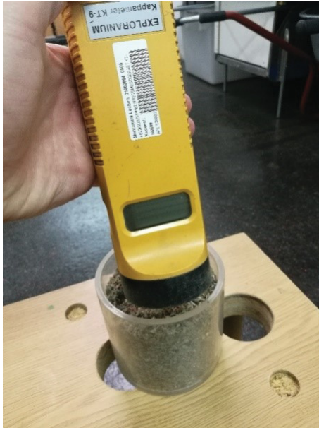
Abb. 2: Bulk-Messungen zur Bestimmung der magnetischen Suszeptibilität mittels Exploranium KT-9.
