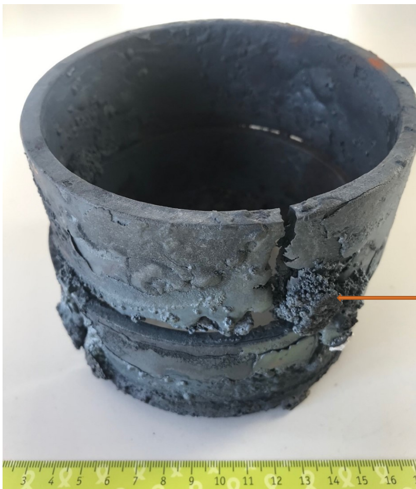
Abbildung 3-9: Rissbildung Reaktormanteldetail 34CrNiMo6, ca. 1450 °C, f=12,5 kHz, P=12 kW
