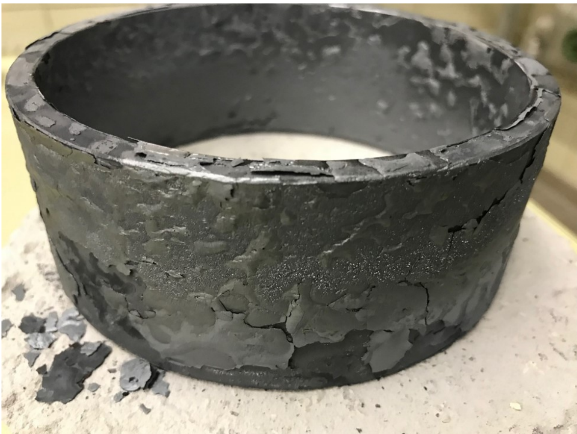
Abbildung 3-7: Zunderbildung bei Erwärmung bis 1.200 °C, f=11,8 kHz, P=9 kW
