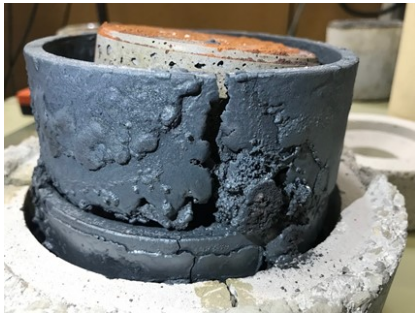
Abbildung 3-8: Rissbildung Reaktormantel 34CrNiMo6, ca. 1450 °C, f=12,5 kHz, P=12,0 kW
