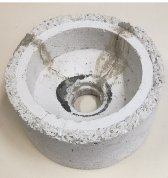
Abbildung 1-20: Reaktorboden mit Rissbildung
