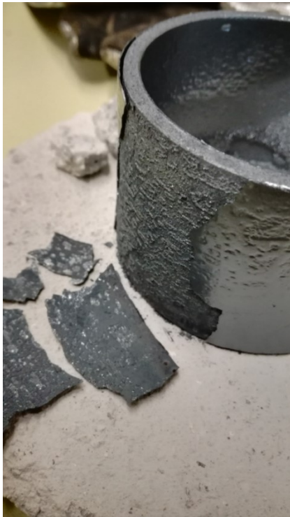
Abbildung 1-4: Zunderbildung Eisenring (34CrNiMo6) durch induktive Erwärmung
