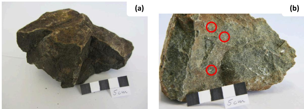
**Abb.8:** Handstücke ausgewählter Harzburgit-Proben **a)** U80 **b)** U125 (rote Kreise markieren Pyroxene).
