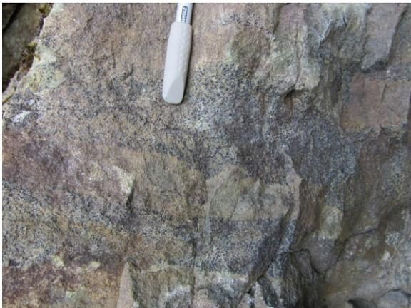
**Abb.17:** Flözzartige Chromitanreicherung mit mehreren Zentimetern Mächtigkeit. Die Aufnahme stammt aus dem Eingangsbereich von Stollen S24 (Aufnahmedatum 26.06.2014), der am 19.07.2014 mit schwerem Gerät verschlossen wurde.
