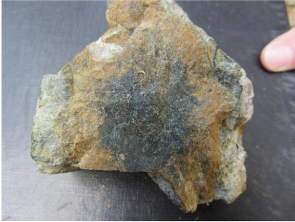
**Abb.15:** Handstück eines Serpentinit, makroskopisch ähnlich der untersuchten Probe U72. Deutlich erkennbare zonierte Verwitterungseinwirkung. Diese Probe stammt aus dem Wintergraben.
