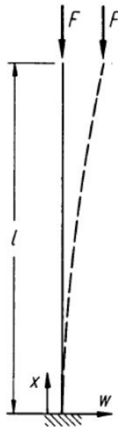
Abbildung 2.23: Mast unter Einzellast
