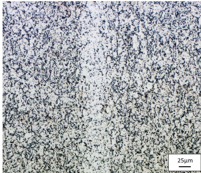
Abbildung 34: Lichtmikroskopische Aufnahme der der Mittenseigerung von Probe Grade 5-1
