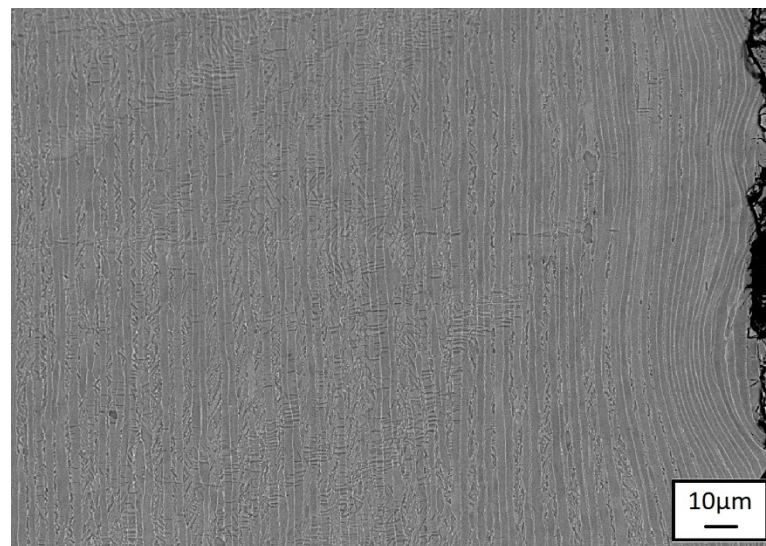
Abbildung 45: REM-Aufnahmen Grade 5-3, Randgefüge (unten), allgemeines Gefüge (oben).
