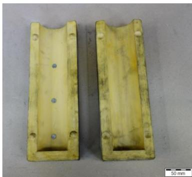
Abbildung 3-13: Verwendeter Kernkasten.
