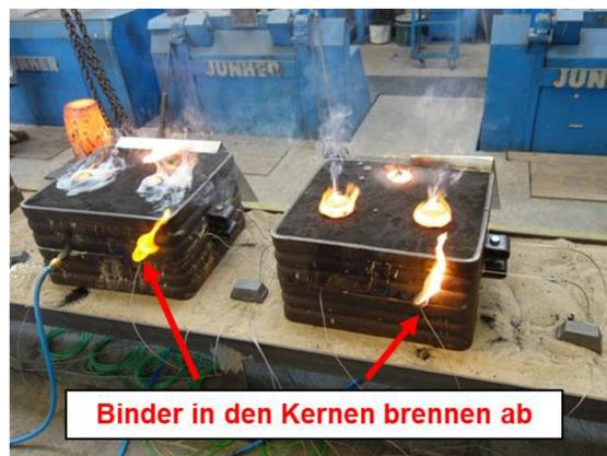
**Abbildung 5-4:** Die Binder in den Kernen brennen ab.
