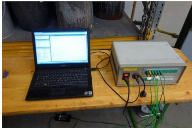
**Abbildung 3-20:** Messverstärker von Gantner Instruments und Laptop mit Software SignaSoft 6000.
