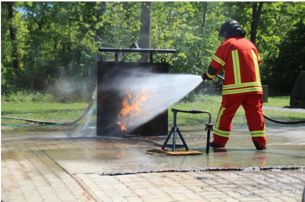
Abbildung 28: Inertisierung der Flamme durch hohen Kühlwasservolumenstrom P005
