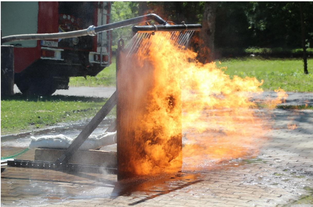
Abbildung 26: Abheben der Flamme bei hohen Kühlwassermengen
