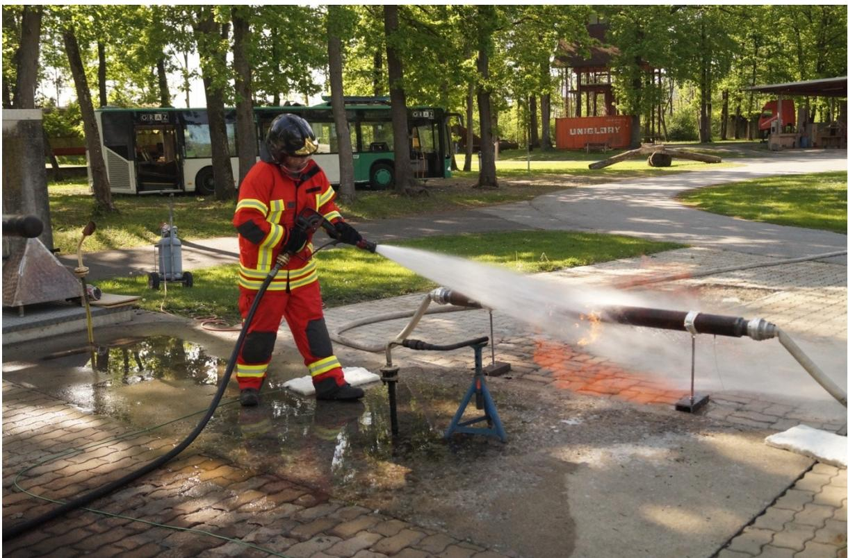
Abbildung 39: Kühlen mit Hochdruckschnellangriffseinrichtung
