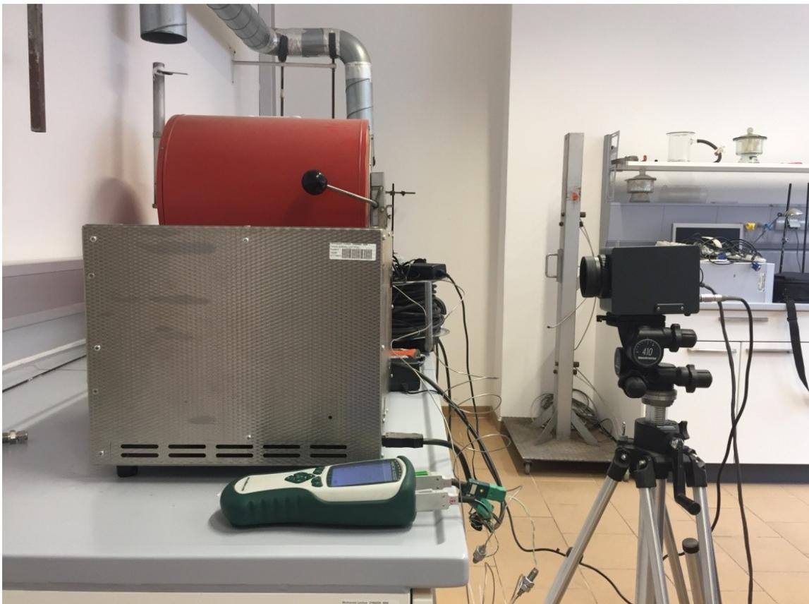
Abbildung 11: Versuchsaufbau Bestimmung des Emissionskoeffizienten
