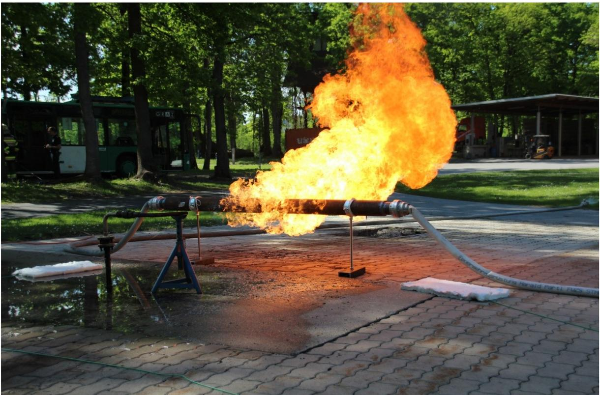
Abbildung 33: Versuchsaufbau Rohrbrandprüfstand R001
