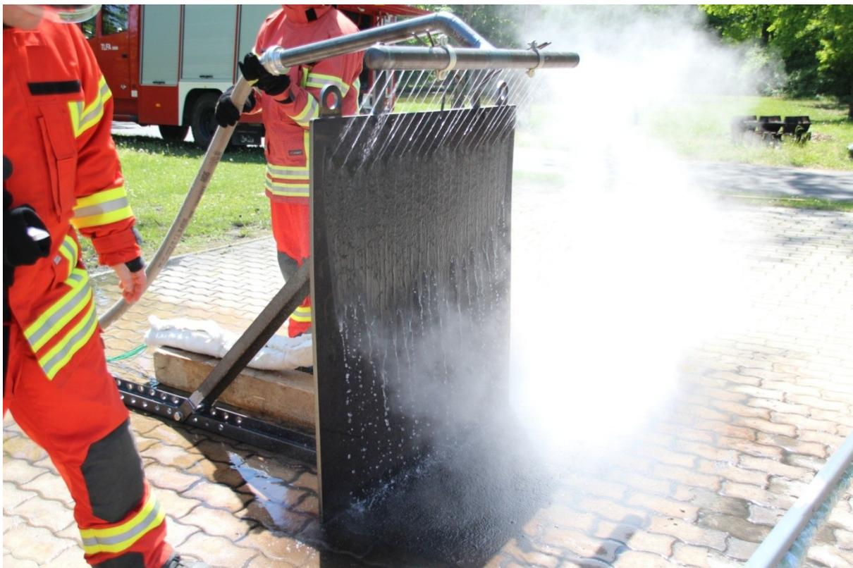
Abbildung 18: Verdampfen des Kühlwassers führt zum Abriss des Wasserfilms
