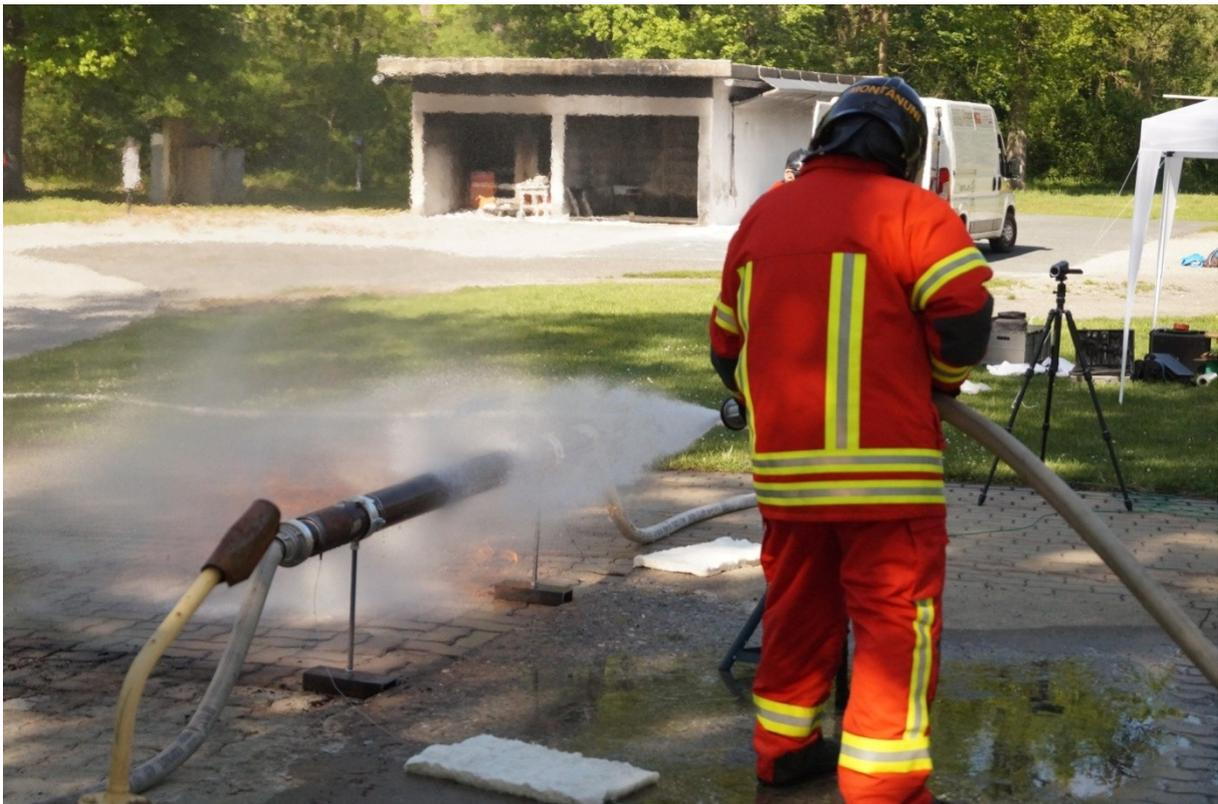
Abbildung 36: Kühlen mit Mehrzweckstrahlrohr R002
