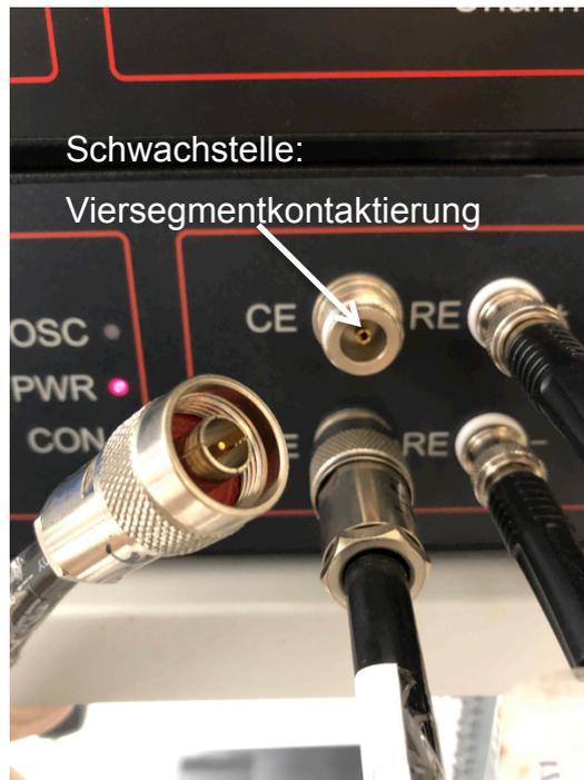
Abbildung 65: Anschluss des CE-Koaxialkabels am *Novocontrol* POT/GAL
