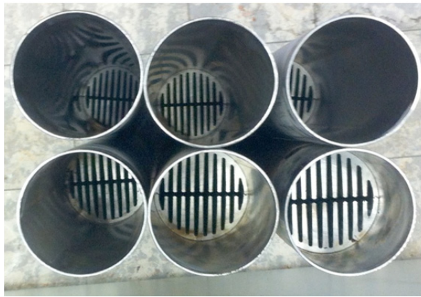
Abbildung 7-3: Sechs Rohre mit unterschiedlich langen aluFer®-Einsätzen
