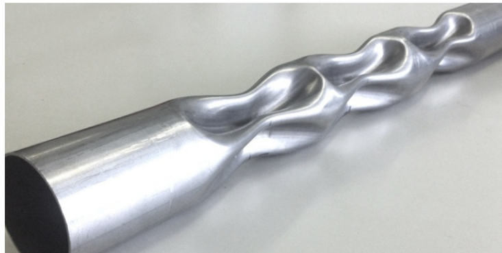
Abbildung 7-13: Alternativer Wärmeübertrager mit Sicken
