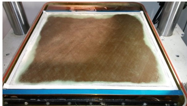
Abbildung 11.6: Imprägnierprozess des trockenen Glasfaserstapels mit a) trockenem Faserstapel, b) aufgebrachtem Imprägnierharz und c) durchimprägniertem Textilfaserstapel.
