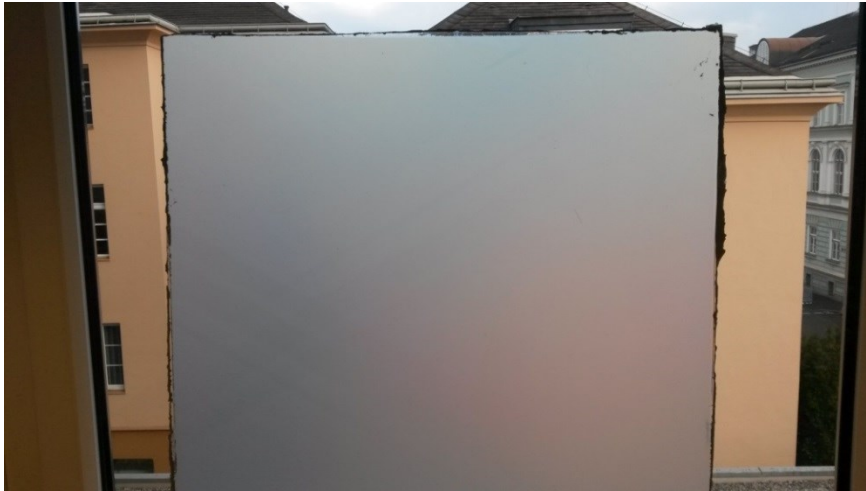
Abbildung 11.8: Optische Kontrolle der Plattenqualität im Durchlichtverfahren.
