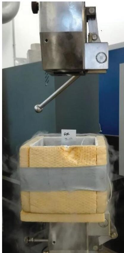
Abbildung 21: Aufgesetzte Kammer mit eingespannter Flachprobe unter Flüssigstickstoff
