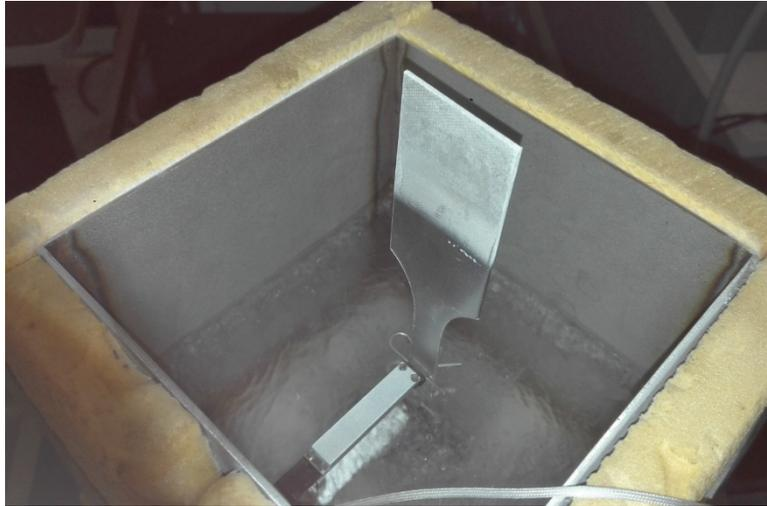
Abbildung 20: Kryokammer zur Hälfte gefüllt mit flüssigen Stickstoff mit eingespannter Flachprobe und Extensometer
