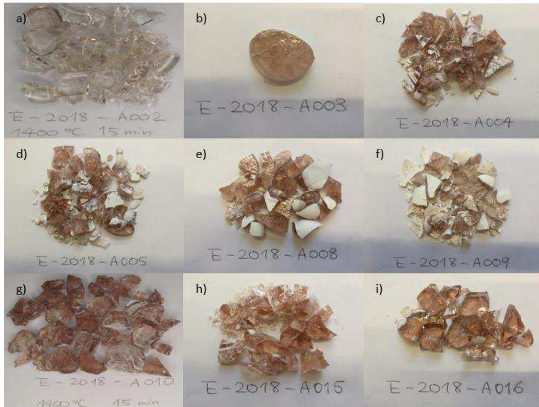
Figure 17. Quenched slags of a) A002, b) A003, c) A004, d) A005, e) A008, f) A009, g) A010, h) A015, and i) A016.
