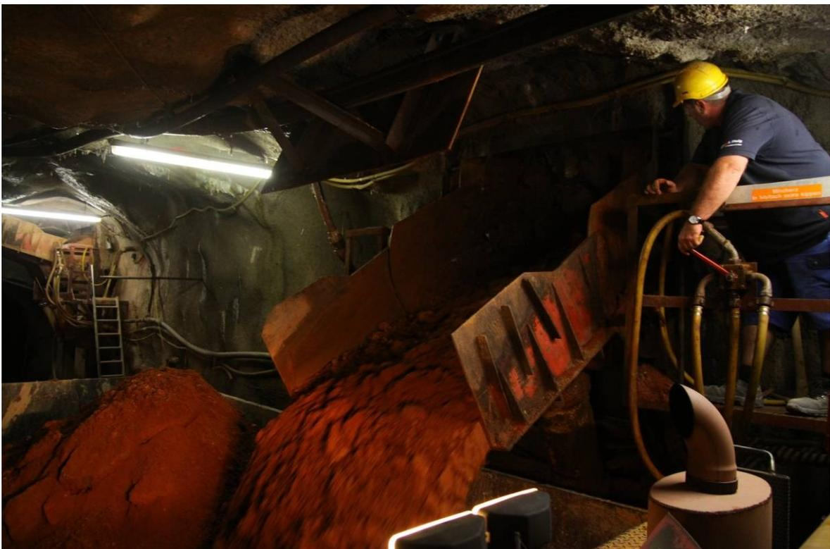
**Abbildung 7: Bedienung der pneumatischen Rollenschnäbel auf der 18. Sohle**
