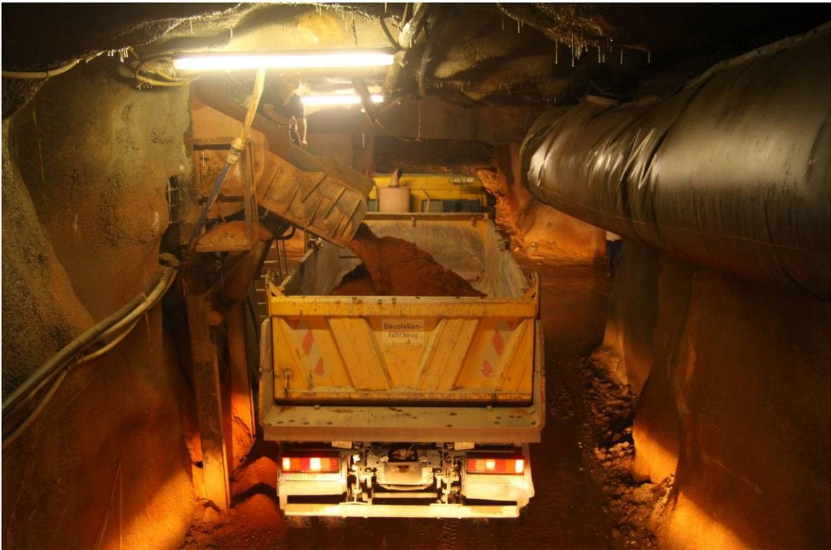
**Abbildung 6: LKW-Beladung aus einer Erzrolle auf der 18. Sohle**
