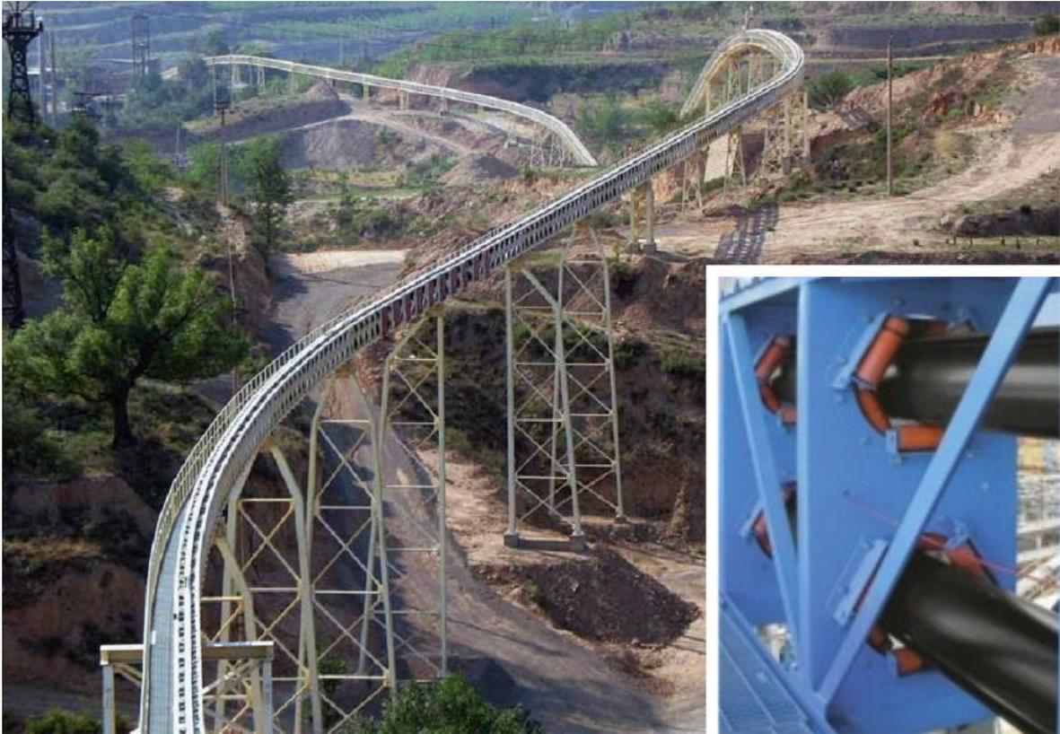
**Abbildung 21: Trassenführung, Trag- und Führungsstation eines Schlauchgurtt Förderers [8]**
