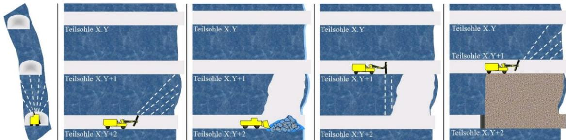
**Abbildung 4: Abbausequenz Teilsohlenweitungsbaus (Aufbruch mittels Fächerbohrung, wegfordern des Hauwerks, Erweitern des Abbaus, Versetzen und Nutzung als Arbeitsfläche für die darüber liegende Teilsohle) [1]**
