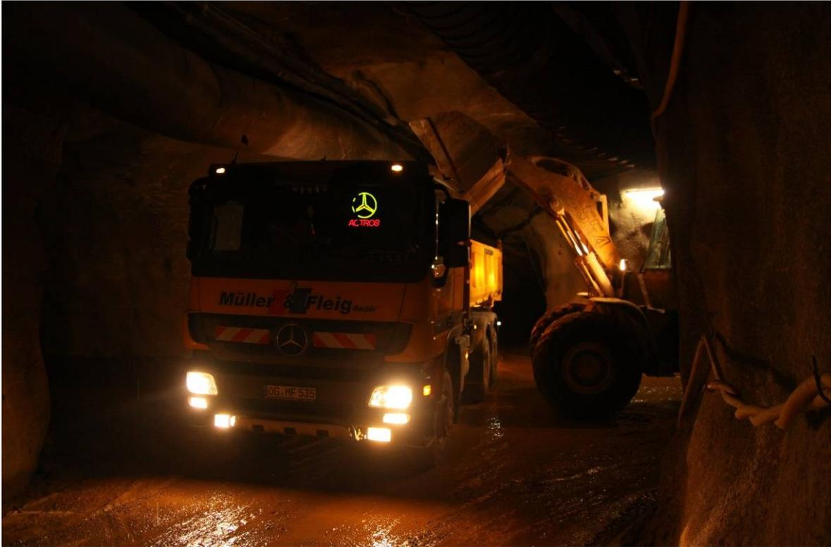
**Abbildung 8: LKW-Beladung mittels Radlader auf Teilsohle 18.2**
