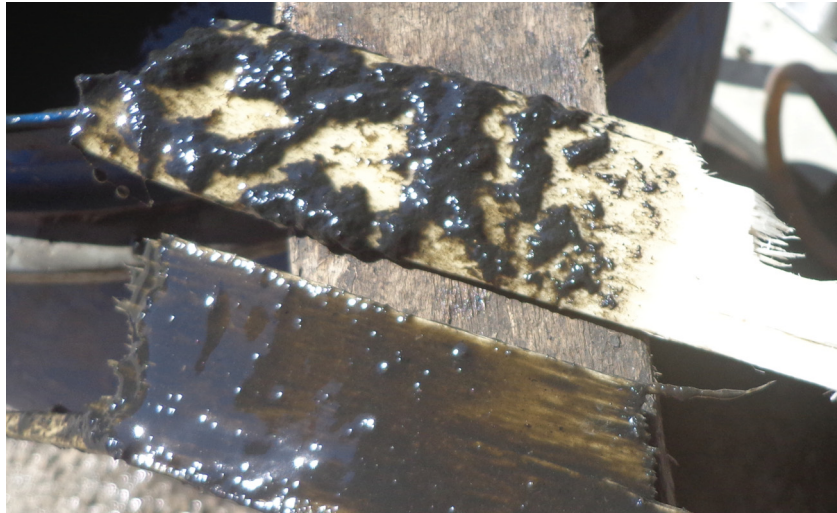
Abbildung 7.8: Auswirkung der Zugabe von Flockungsmittel: kaum geflockter Schlamm (unterer Bereich des Bildes) im Vergleich zu gut geflocktem Schlamm (oberer Bereich des Bildes)
