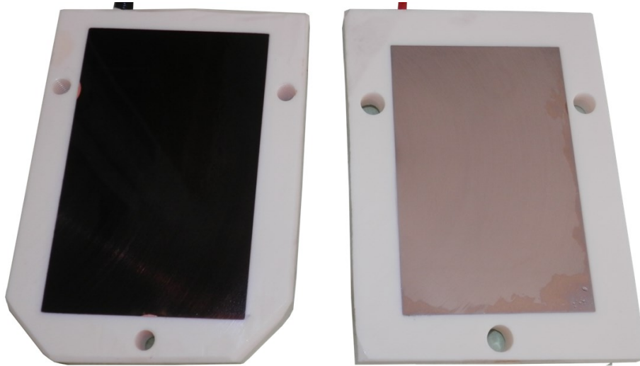
Abbildung 6.16: Fotos der Elektroden nach 220 Stunden Einsatz; links: Kupferkathode; rechts: Stahlanode
